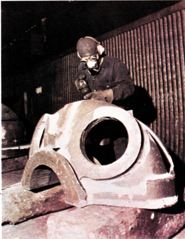
Oberflächenreinigung eines Gasturbinengehäuses mit einem Druckluft-Schweißhammer.
