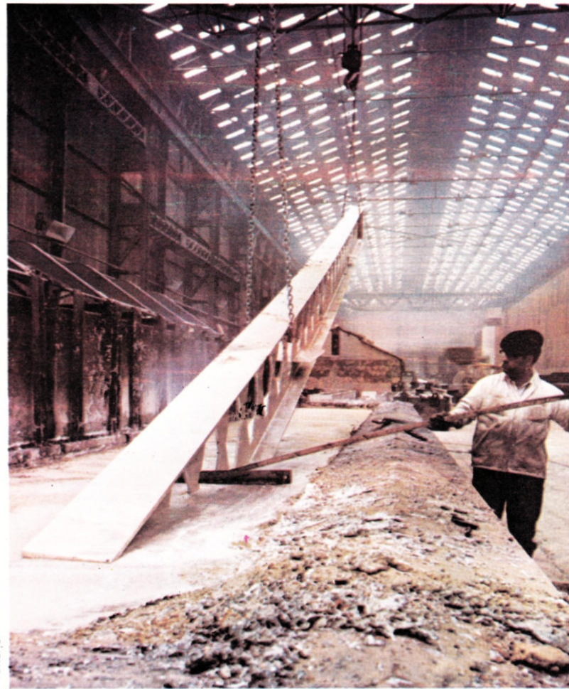
Eines der größten Heiß-Zinktauchbäder der Welt. Es ist etwa 17 m lang, 2,50 m tief und faßt 1100 t Zink.
