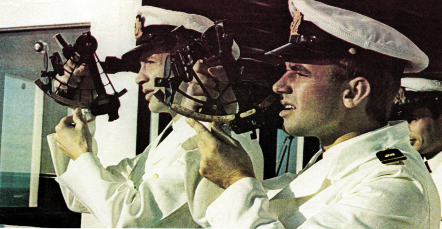
Oben: Der Sextant ist eines der wichtigsten Navigationsinstrumente der Schifffahrt. Hier Offiziere bei der Positionsbestimmung auf der TS 'Bremen'.
