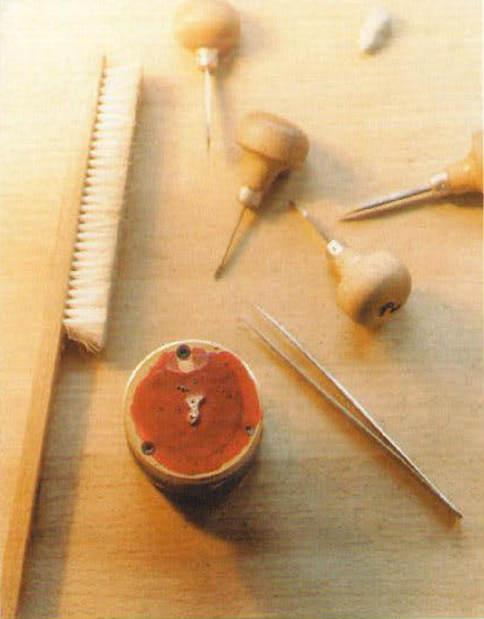
Auch in Kleinigkeiten perfekt: Mit Gravur-Werkzeugen werden selbst winzige Teile verziert, wie der in Siegellack fixierte Unruhkloben. Die Montage unter Kunstlicht bei Glashütte Original erfordert Stille und volle Konzentration
