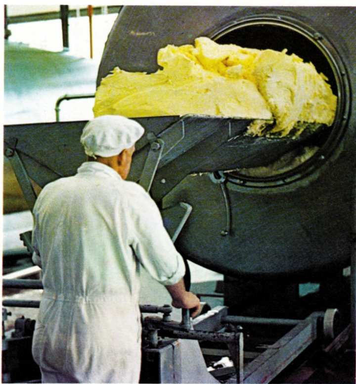
Oben: Herausheben eines großen Butterklotzes aus einer Zentrifuge in einer Molkerei in Australien.
