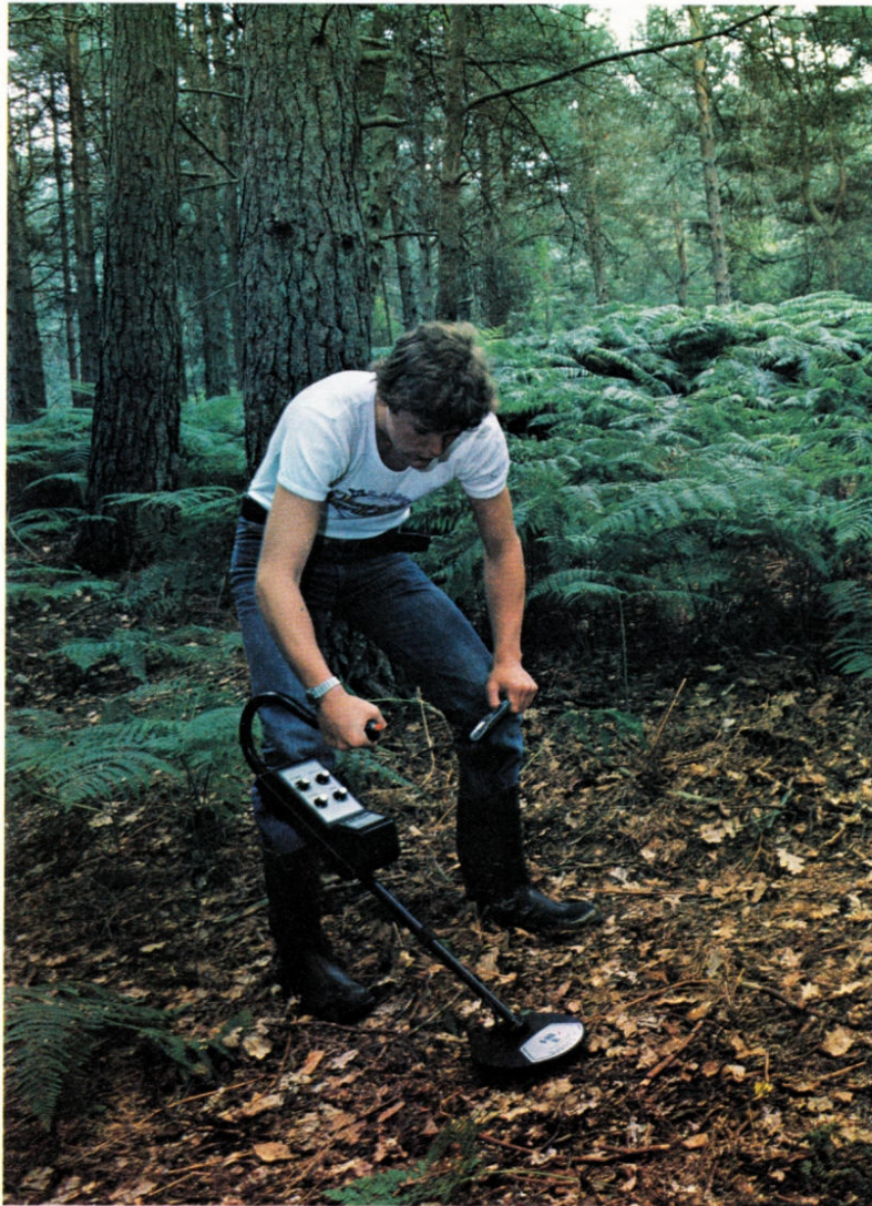
Oben: Die Schatzsuche mit Metalldetektoren ist in den letzten zehn Jahren ein beliebtes Hobby geworden. Die Detektoren haben Ausgleichsspulen oder sind heterodyne Geräte.
