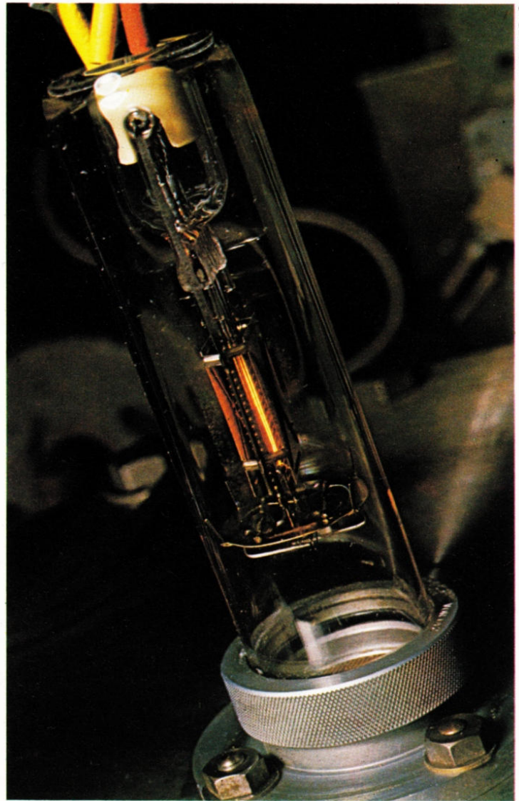
Oben: Ein Ionen-Druckmesser, der zum Messen extrem niedriger Drücke verwendet wird. Im Inneren: eine Katode.
