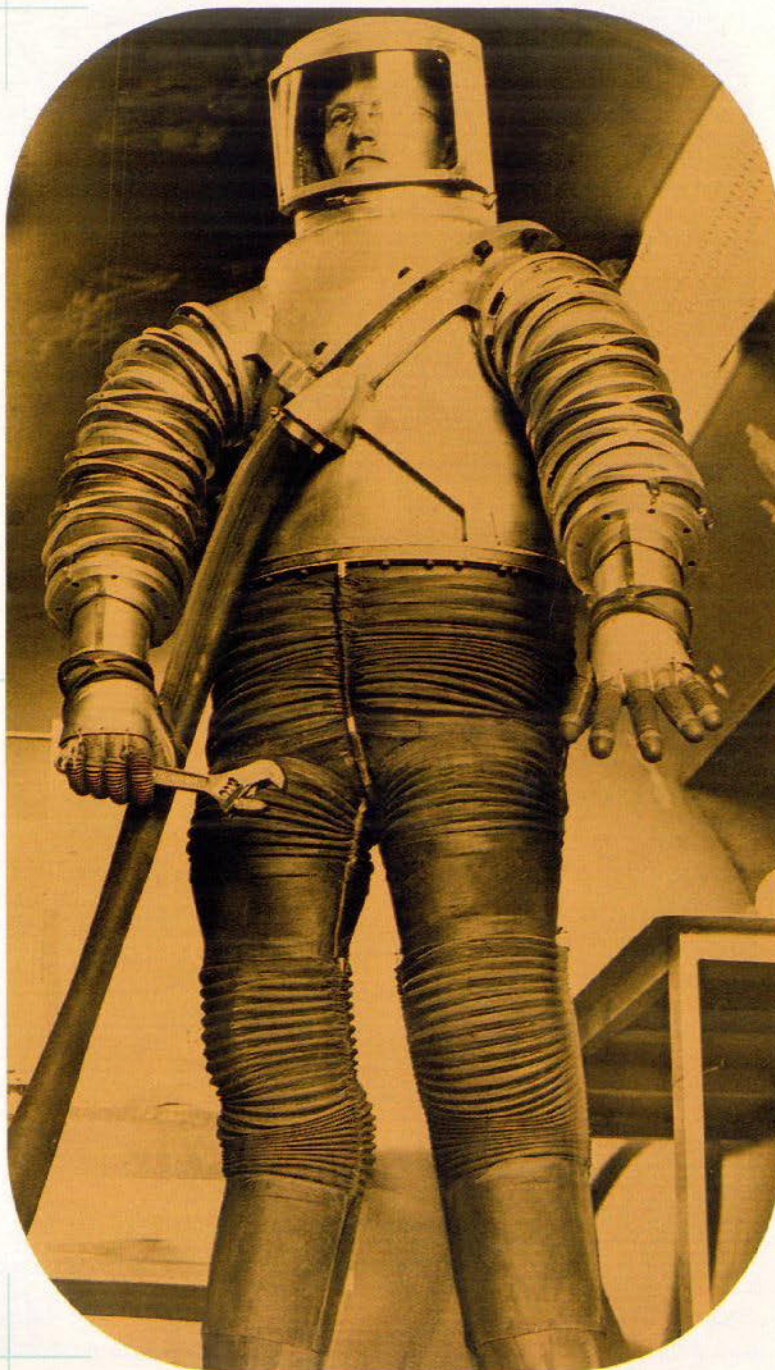
Der Litton Mark I, in den 1950er Jahren zunächst für die Arbeit in VAKUUMKAMMERN entwickelt, interessierte auch die US-Luftwaffe. Mit seinem Aluminiumtorso war er der Vorläufer moderner »Hard-Suits«
