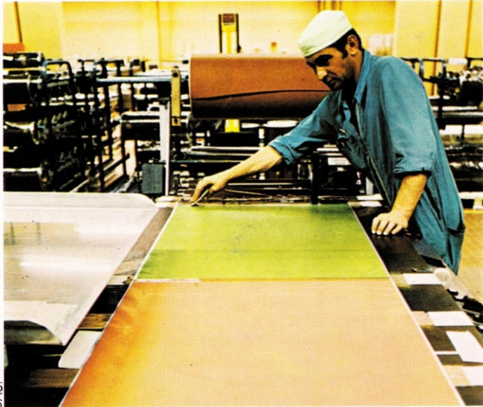
Oben: Das sogenannte 'Führungsband' wird vorbereitet. Es wird dann an die Enden des Magnetbandes geklebt; an ein Ende kommt ein rotes, ans andere ein grünes Band.
