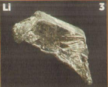
LITHIUM: das leichteste aller Metalle, wird in Batterien etwa für Uhren, Funkgeräte, Fernbedienungen eingesetzt
