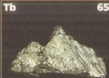
TERBIUM: sehr weiches Element, Verwendung in der Lasertechnik und in Sonargeräten zur Unterwasser-Ortung
