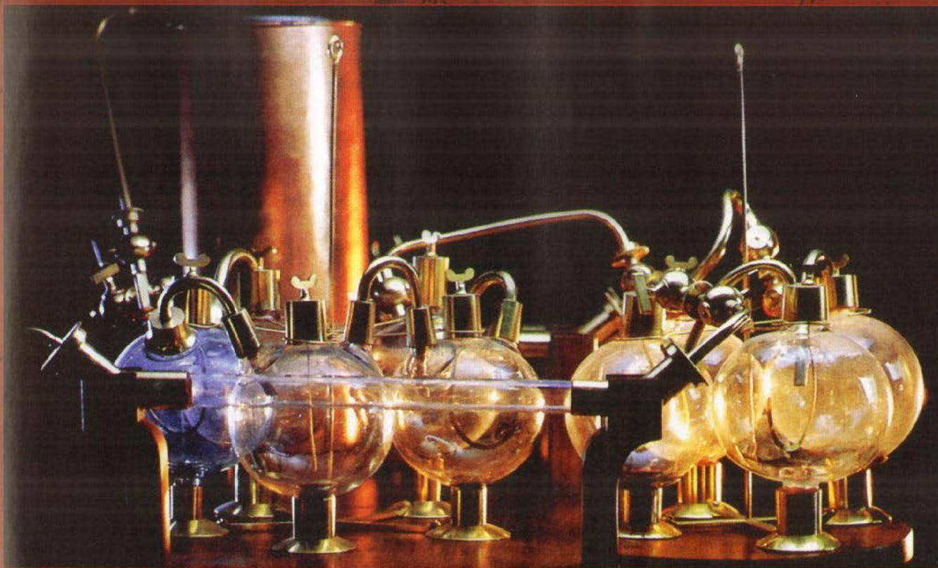
VIELE SEINER APPARATUREN konstruiert Antoine de Lavoisier selbst – etwa dieses ausgeklügelte Instrument, mit dem der Chemiker Substanzen durch Hitze zersetzt und die einzelnen Bestandteile in Glaskugeln auffängt
