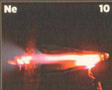
NEON: reaktionsträges Gas, wird in Leuchtstoffröhren durch elektrische Spannung zum Strahlen gebracht
