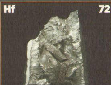
HAFNIUM: hitzebeständiges Element, Rohstoff für spezielle Keramiken und moderne Stahlschneide-Geräte
