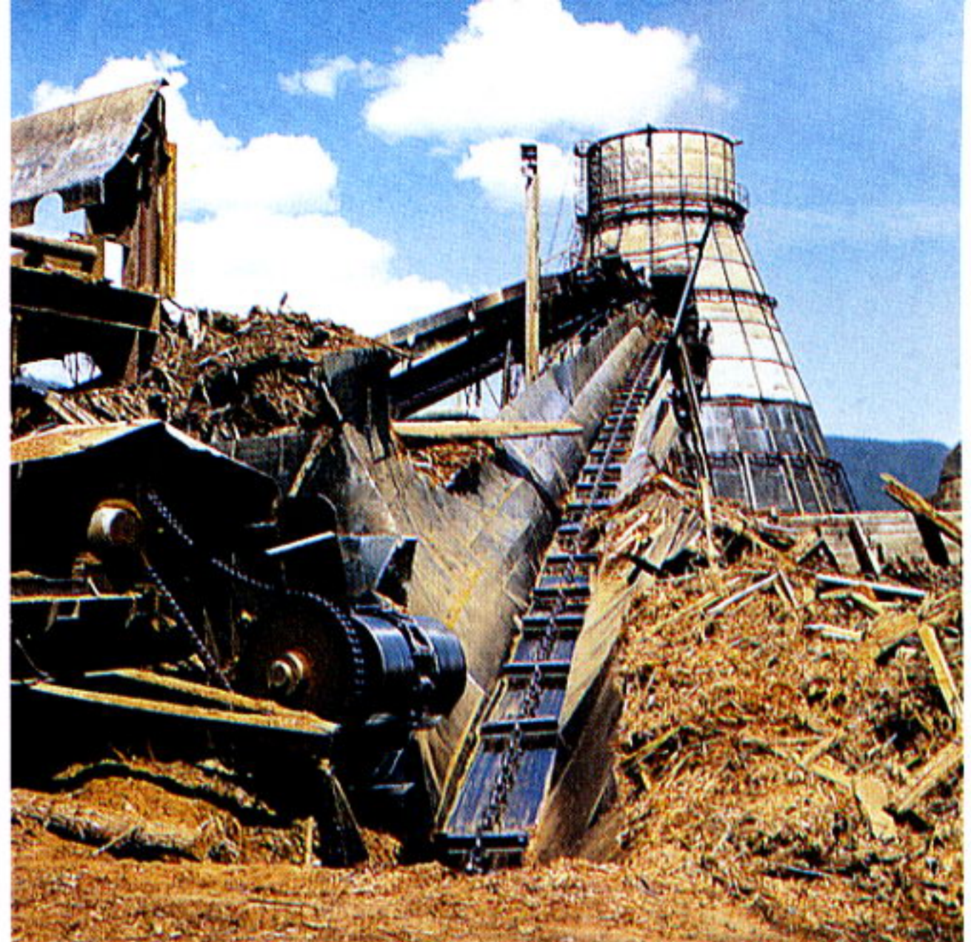
In solchen industriellen Meilern wird in Kanada Holzkohle hergestellt.
