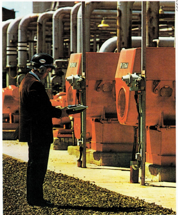
Unten: Lärmmessungen müssen in vielen Industriebetrieben und Büros durchgeführt werden, da Einwirkungen von mehr als 120 dB(A) zu bleibenden Gehörschäden führen. Im Bild hier ein Handmeßgerät.
