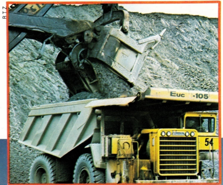
Oben: Kupfergewinnung in Bougainville, Papua Neu Guinea. Kupfererz wird mit einem Eimerbagger in einen Lastwagen verladen.
