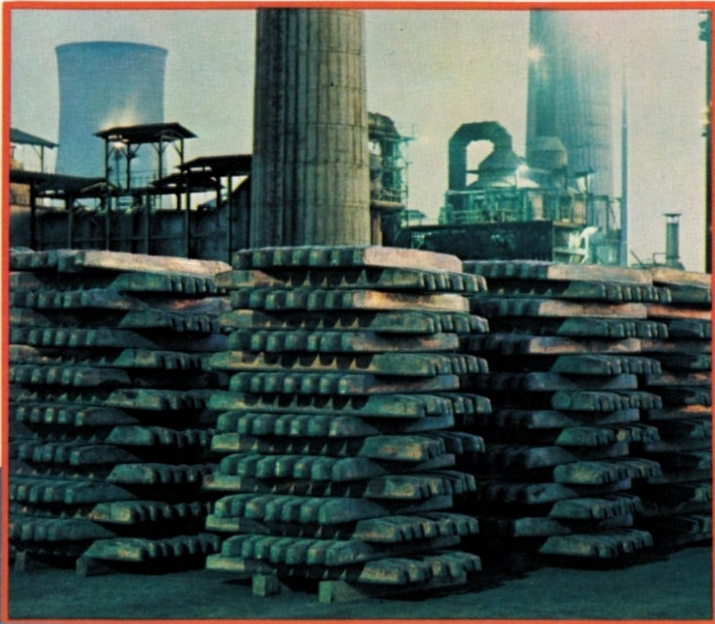
Oben: Kupferbarren, die zu Draht verarbeitet werden, in einer Raffinerie in Südafrika.
