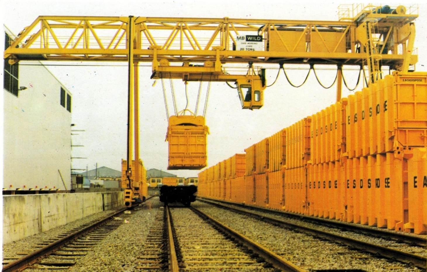
Unten: Containerkran, der auf Schienen läuft und eine Brückenkranstruktur besonderer Art ist.
