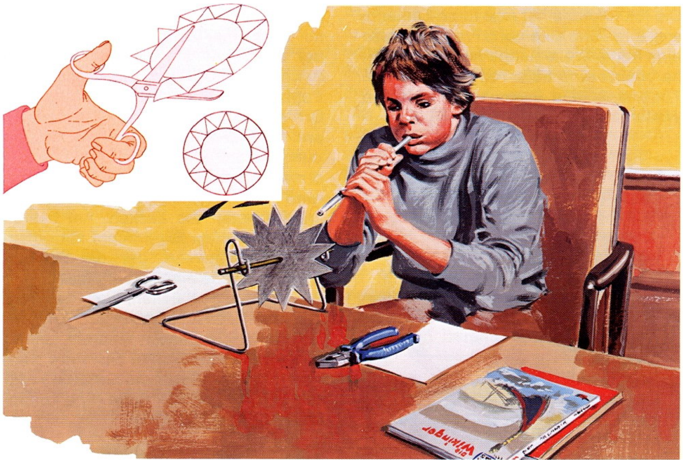
Die Tonhöhe hängt von der Frequenz ab. Je schneller sich das Rad dreht, desto höher ist der Ton.
