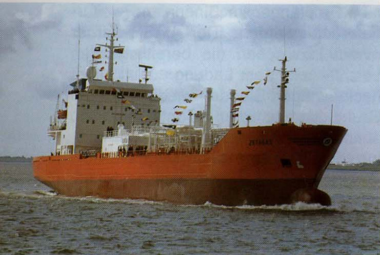
Gastanker mit den typischen Kühlanlagen an Deck.
