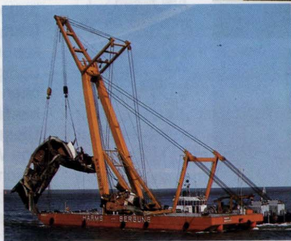
Ein moderner Schwimmkran hat das Wrack eines Binnenschiffes gehoben, das nach einem Zusammenstoß gesunken war.
