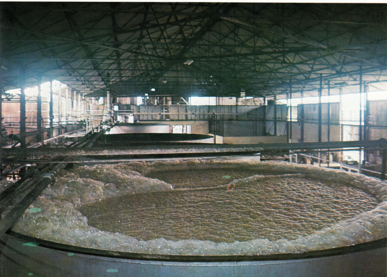
Unten: Vergärungsanlage in einer Rumfabrik auf den Westindischen Inseln. Der Alkohol entsteht, wenn beim Gärprozeß die Sauerstoffzufuhr beschränkt wird. Die Hefe zersetzt dann Zucker zu Alkohol und Sauerstoff unter Freisetzen von Kohlenstoff.
