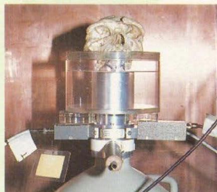
Im Spektrometer registriert ein Germanium-Detektor schwache Gammastrahlung
