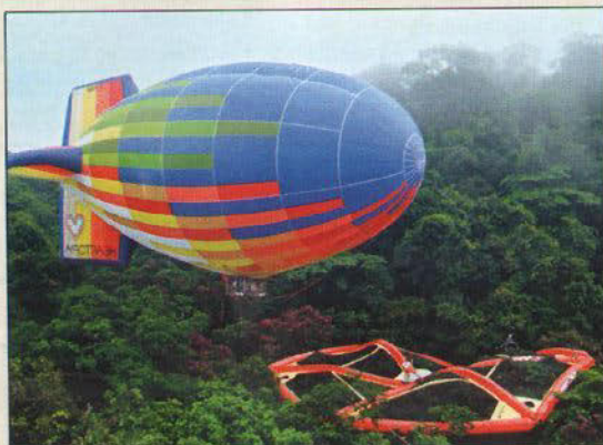
Ein per Luftschiff abgesetztes Plastik-Plateau ermöglicht es Francis Hallé, die Wipfelregionen tropischer Bäume zu erforschen
