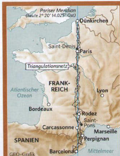
Delambre und Méchain vermessen per Triangulation die exakte Entfernung zwischen Dünkirchen und Barcelona – und leiten daraus das Meter ab
