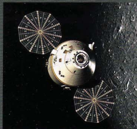
Das Raumschiff »Orion« soll die Spaceshuttles ablösen, die voraussichtlich 2010 ausgemustert werden. Das wiederverwendbare Crew-Modul wiegt 25 Tonnen
