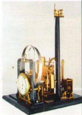
Ein Seismograph zum Messen von Erdbebenwellen aus dem Jahr 1885, gebaut nach Entwürfen von John Milne
