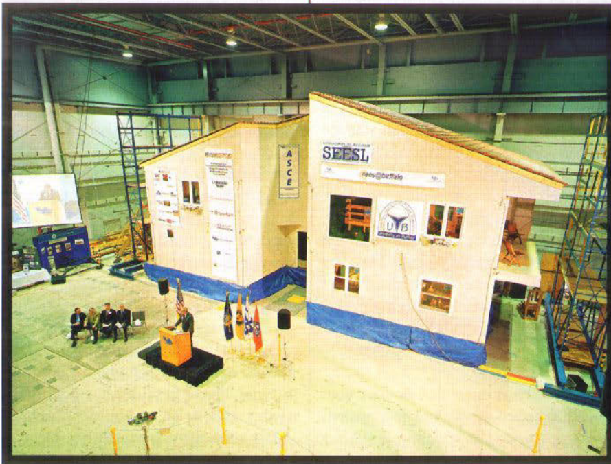
Auf einem riesigen Rütteltisch im Forschungslabor der US-Universität in Buffalo testen Ingenieure mehrstöckige Holzhäuser, um erdbebensichere Konstruktionen zu entwickeln
