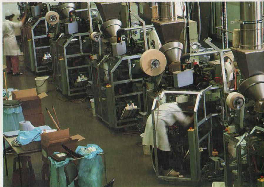
Maschinelle Kräutertee-Abpackung in den Bad Wörishofener Kneipp-Werken
