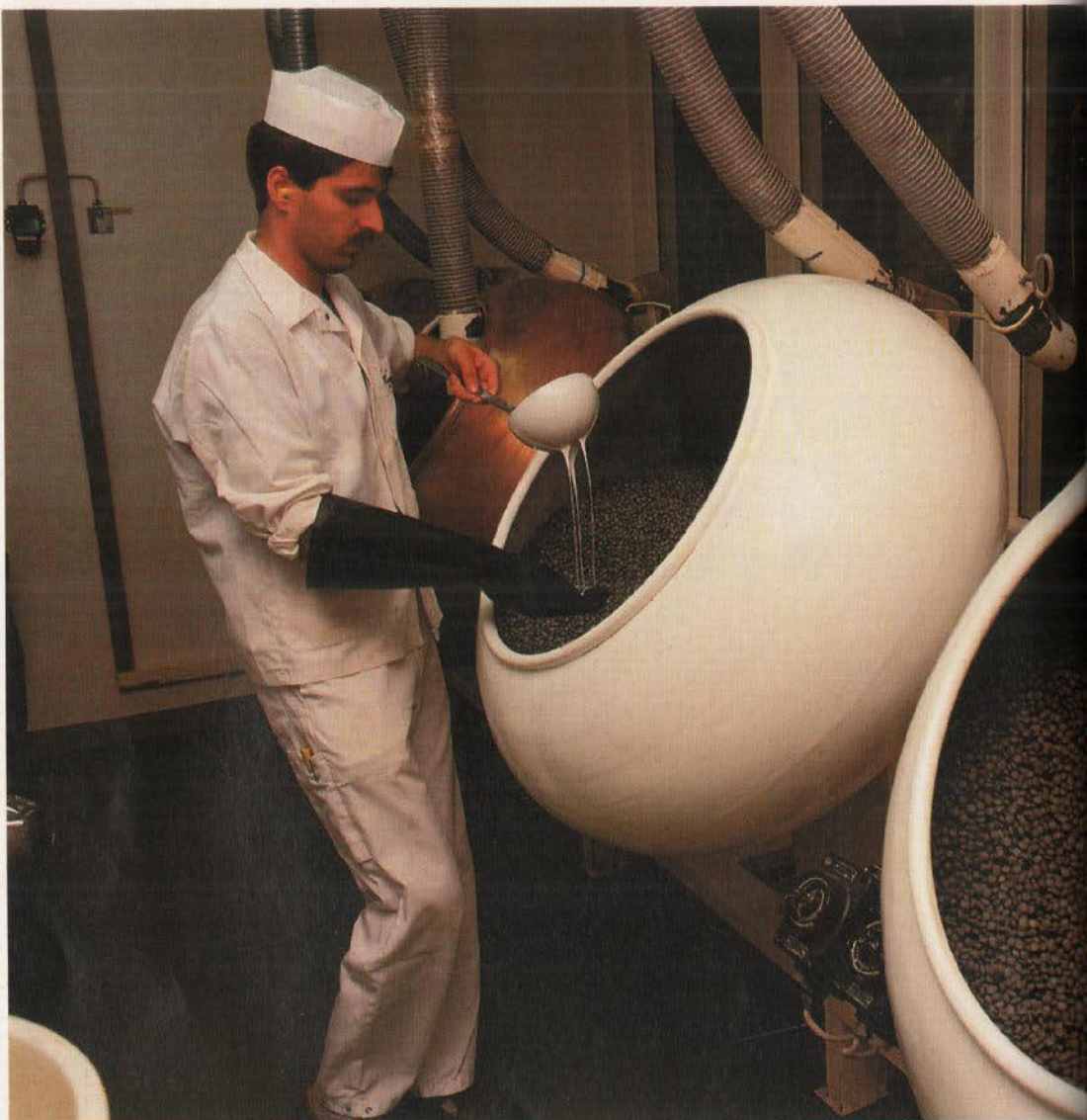
»Kerne«, die Mistelextrakt enthalten, bekommen bei den Kneipp-Werken eine schützende Schellack-Hülle
