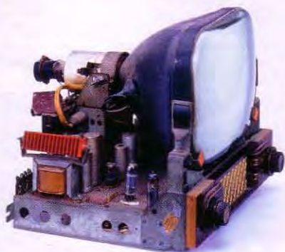
Der Kern des »Illustra« von 1953 ist eine Bildröhre, die mit Elektronenstrahlen Lichtpunkte erzeugt
