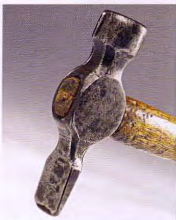
Die beschleunigte Masse des Hammerkopfes überträgt beim Aufprall Energie
