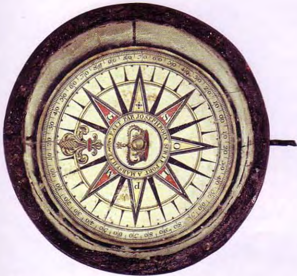
Die Windrose erleichtert das präzise Navigieren mit einem Kompass wie diesem aus dem Jahr 1775
