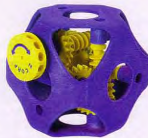
Modell aus dem 3-D-Drucker: Schicht für Schicht trägt das Gerät unterschiedlich gefärbte Pulver auf, die verfestigt und dann mit einem Kleber konserviert werden
