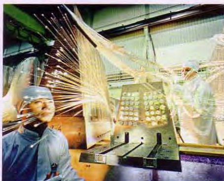
Lichtleiter aus Quarz: In Glasfasern lassen sich optische Signale schnell über weite Strecken senden (hier im Genfer Forschungszentrum CERN)
