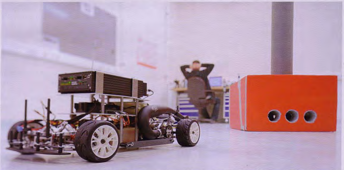
Mithilfe von Modellautos testen die Wolfsburger Ingenieure, wie Sensoren (etwa ein Radargerät) und die borgelegenen Steuersysteme miteinander harmonisieren, wenn sie ihnen Hindernisse (oben rechts, aus rotem Schaumstoff) in den Weg stellen
