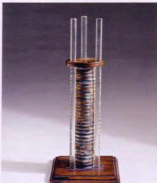
Schichten aus Kupfer- und Zinkplättchen sowie in Salzwasser getränkten Pappscheiben bilden Voltas elektrische Säule
