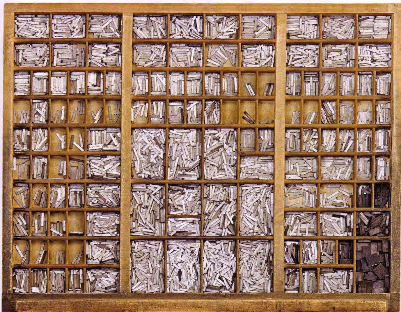
Historischer Setzkasten mit Bleilettern: Buchstabe für Buchstabe müssen Texte für den Druck zusammengefügt werden – bis sich ab 1886 automatische Setzmaschinen etablieren
