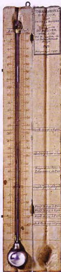
Thermometer von 1790: Je höher die Temperatur, desto stärker dehnt sich Quecksilber aus und steigt in der Glassäule nach oben
