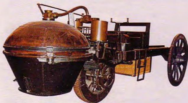
Das erste Automobil wird 1769 von dem Franzosen Nicolas Cugnot vorgestellt – und bewegt sich noch per Dampfkraft 81
