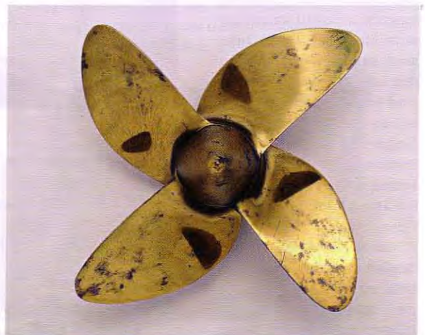
Antrieb der »TS Mauretania«: Schiffspropeller aus Bronze von 1906
