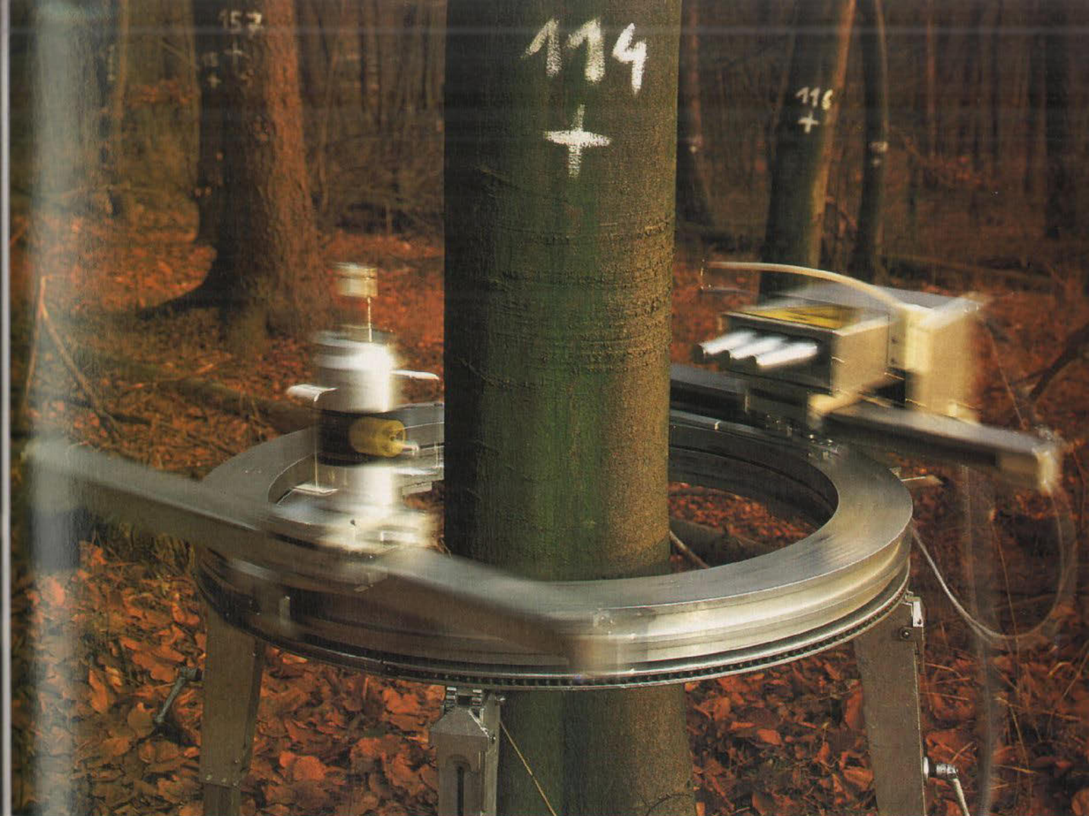
Röntgenstrahlen sollen das Innenleben eines Buchenstammes offenbaren
