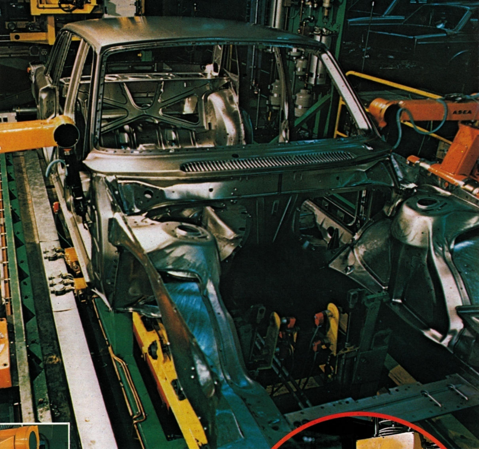
Oben: Zwei Industrieroboter für 6 kg Nutzlast zum Kontrollmessen von Kraftfahrzeug-Karosserien im Werk Torslanda der Firma Volvo, in Schweden.
