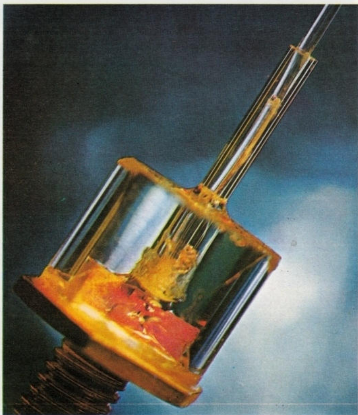
Oben: Ein Laserstrahl wird in einem optischen Kommunikationssystem eingesetzt. Die Impulse des Laserstrahls variieren entsprechend der Eingabesignale. Das Licht pflanzt sich in einer 1 mm dicken optischen Faser fort. Dieses Lichtsignal ist frei von elektrischen oder magnetischen Störungen.
