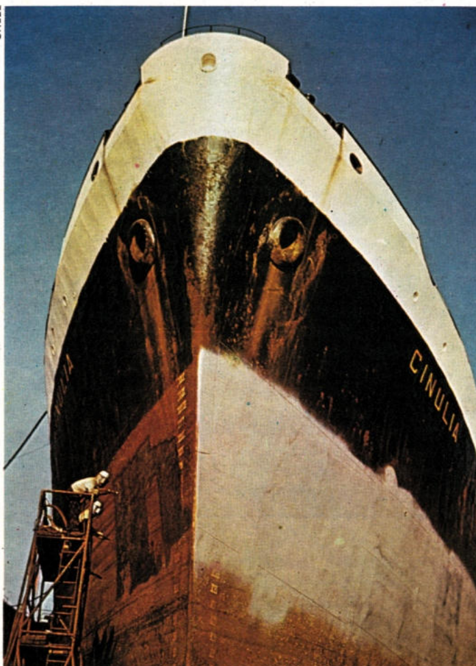
Oben: Der Rumpf des Tankers 'Cinulia', der mit Fäulnisverhütungsanstrichen behandelt wurde. Ein starker Bewuchs an einem Schiff führt zu einer großen Geschwindigkeitsverringerung; außerdem ist bei gleicher Geschwindigkeit der Brennstoffverbrauch bedeutend höher da der Leistungsabfall überwunden werden muß.
