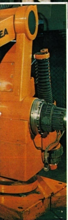
Oben: Zwei Industrieroboter für 6 kg Nutzlast zum Kontrollmessen von Kraftfahrzeug-Karosserien im Werk Torslanda der Firma Volvo, in Schweden.
