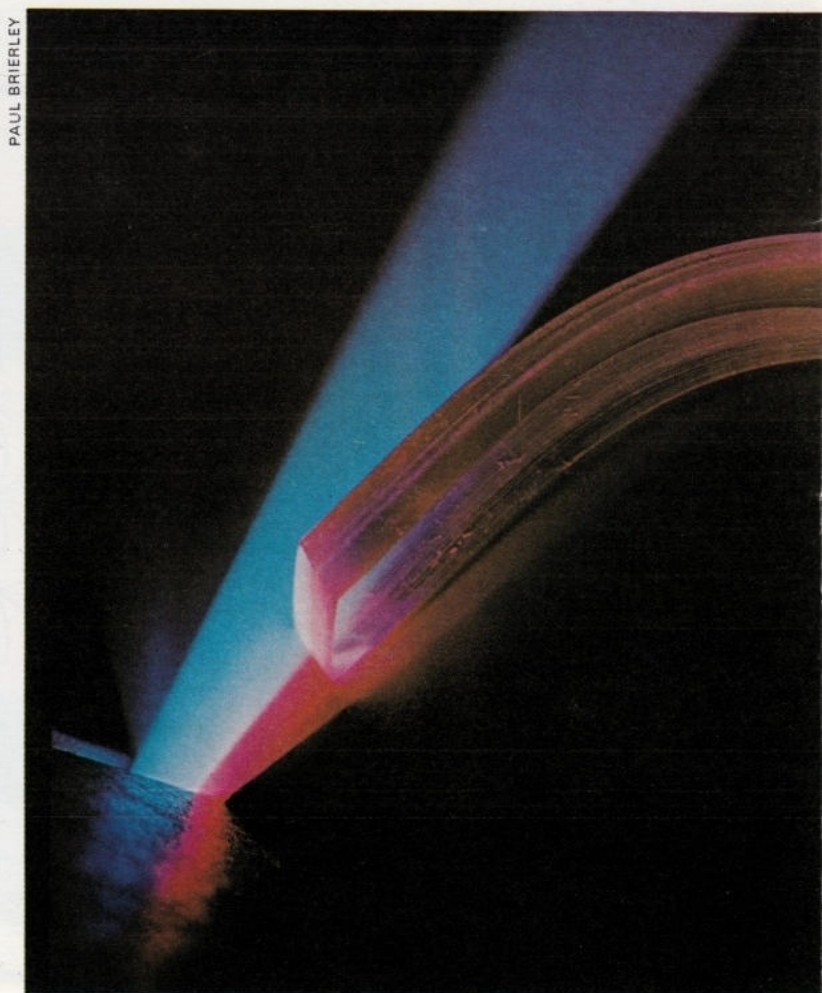
Oben: Ein Laserstrahl wird in einem optischen Kommunikationssystem eingesetzt. Die Impulse des Laserstrahls variieren entsprechend der Eingabesignale. Das Licht pflanzt sich in einer 1 mm dicken optischen Faser fort. Dieses Lichtsignal ist frei von elektrischen oder magnetischen Störungen.
