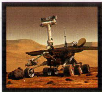
Mit einer »Möbbauer-Sonde« erfassen Mars-Rover den Eisengehalt von Gestein
