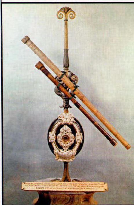
Galileis Fernrohr: Seine Instrumente baut der Forscher selbst – aus Holz, Leder, Kupfer und Papier. Nur die Linsen lässt er schleifen
