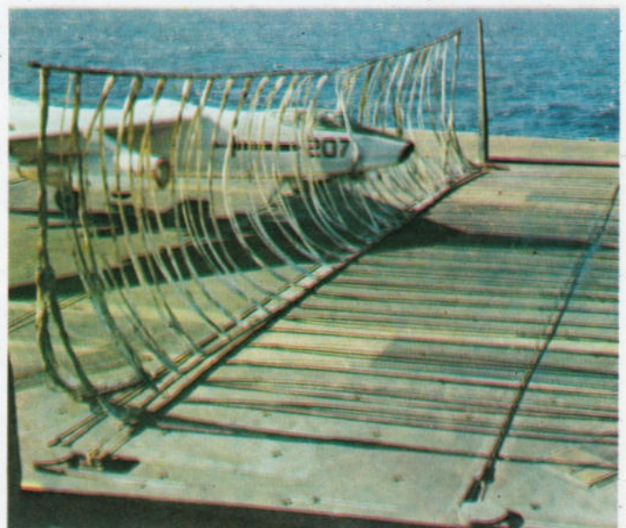
Oben: Manchmal kann ein Flugzeug keine Fangseile verwenden. Es wird dann durch Fangnetze gestoppt.
