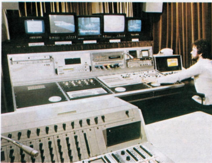
Oben: Ein Kontrollraum im 'Studio Hamburg' (ARD). Die Position und Stärke der Beleuchtung werden von hier aus kontrolliert. Der Bildtechniker prüft die Bildqualität.
