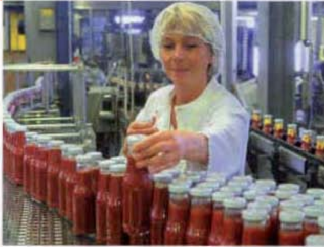
Die Verpackung muss steril, also frei von Mikroorganismen sein. Bei der Vakuumverpackung wird außerdem die verbleibende Luft entfernt, sodass kein Sauerstoff mehr vorhanden ist.
