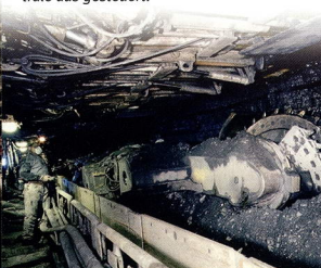
Der Walzenschrämlader im Schildstreb wird nicht vor Ort, sondern von einer Zentrale aus gesteuert.
