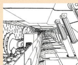
Stahlschilde schirmen beim modernen Schreitausbau den Streb ab.
