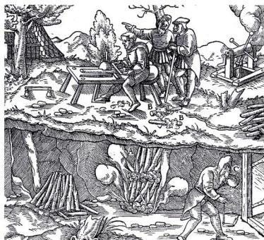
Das Feuersetzen war eine übliche Methode Erze abzubauen.
