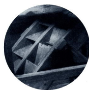
Kehrrad (Ausschnitt) mit entgegengesetzt ausgerichtetem Schaufelkranz (Museum St. Andreasberg, Oberharz)
