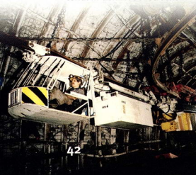
Die Einschienenhängebahn befördert Bergleute und Material in den Nebestrecken.
