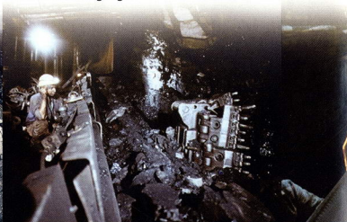
Der Kohlenhobel arbeitet häufig vollautomatisch. Die Männer vor Ort kontrollieren den Arbeitsvorgang.
