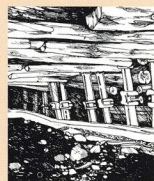
Beim Strebabau um 1950 benutzte man Holzkappen und Stahlstempel.
