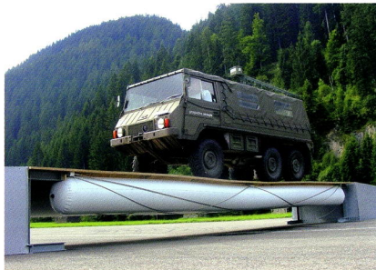
Damit diese luftgefüllte Brücke bei einem Riss nicht zusammenbricht, soll zukünftig eine Hülle verwendet werden, die Löcher von selbst verschließen kann.
