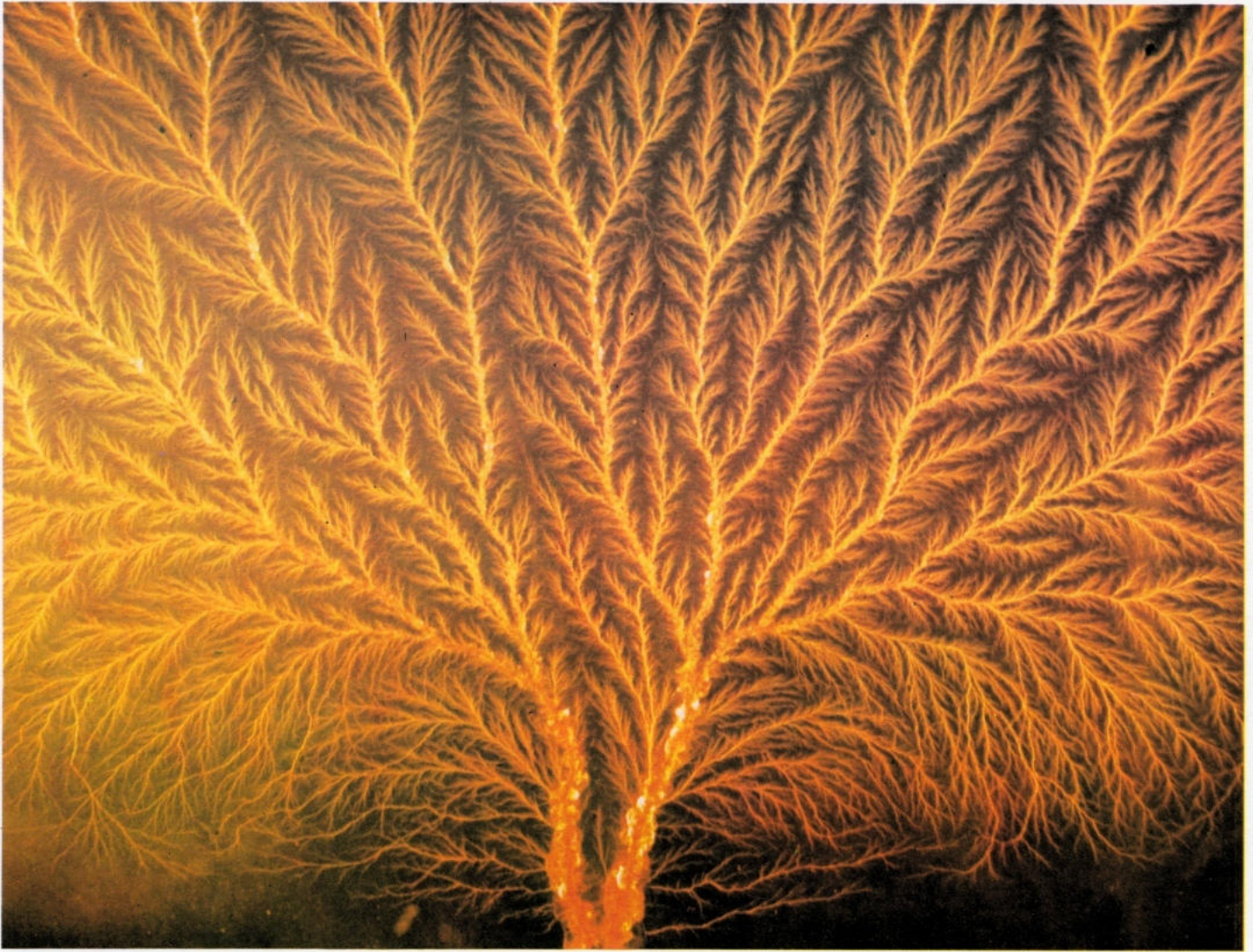
Diese Plexiglasscheibe wurde aufgeladen, indem man einen hoch-energetischen Elektronenstrahl hindurchschickte. Durch Erden einer Seite entstand dieses Entladungsmuster.
