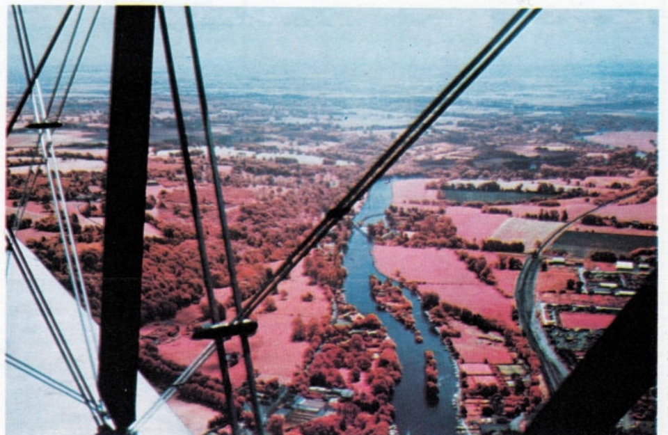
Unten: Eine Luftaufnahme mit einer Infrarotkamera. Kalte Flächen sind blau, wärmere Flächen erscheinen rötlich.
