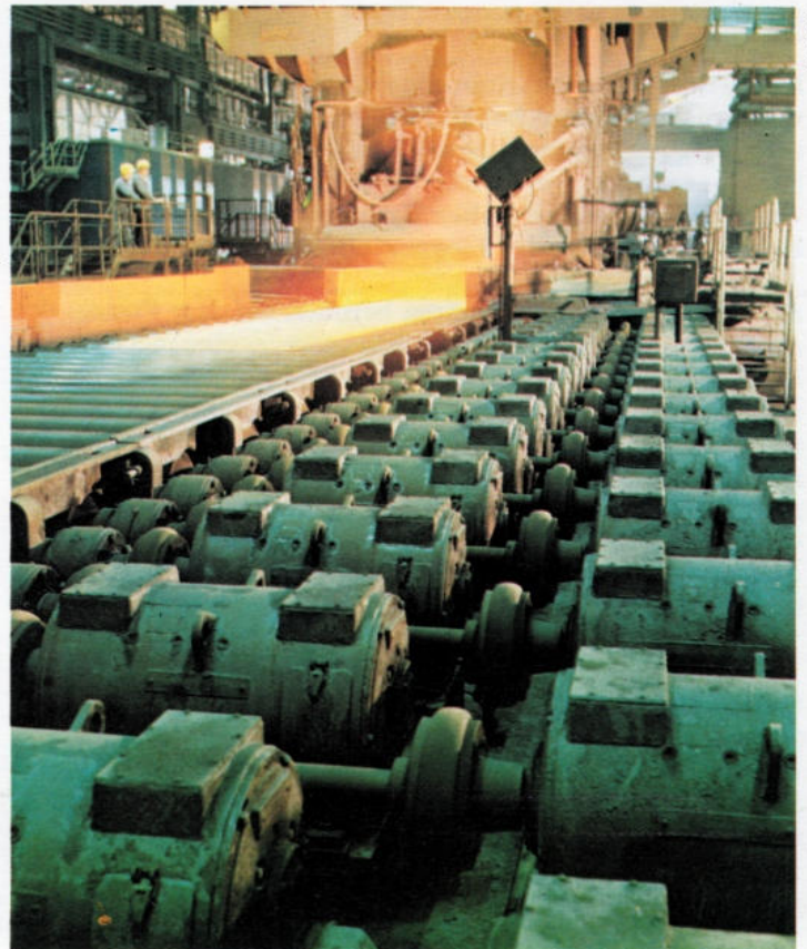
Oben: Das Bild zeigt eine Grobblechstraße mit Umkehr-Quartogerüst im Hüttenwerk Raabe in Finnland. Im Vordergrund sind die Gleichstrom-Hüttenwerksmotoren zum Antrieb des Rollganges. Diese Motoren sind zum Antrieb zweier Grobblechstraßen und einer Tandem-Warmbandstraße geeignet.
