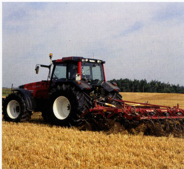
Der Grubber lockert den Boden mit mehreren Zinken, wendet ihn aber nicht.
