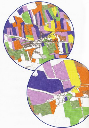
Bei der Flurbereinigung werden Äcker, Wiesen, Wege und Straßen genau vermessen und zersplitterte Grundstücke zu größeren zusammengelegt.
