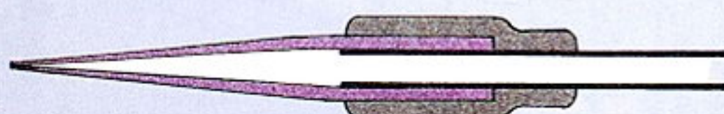
Die Rohrblatthälften sind zusammengedrückt und unterbrechen den Luftstrom.
