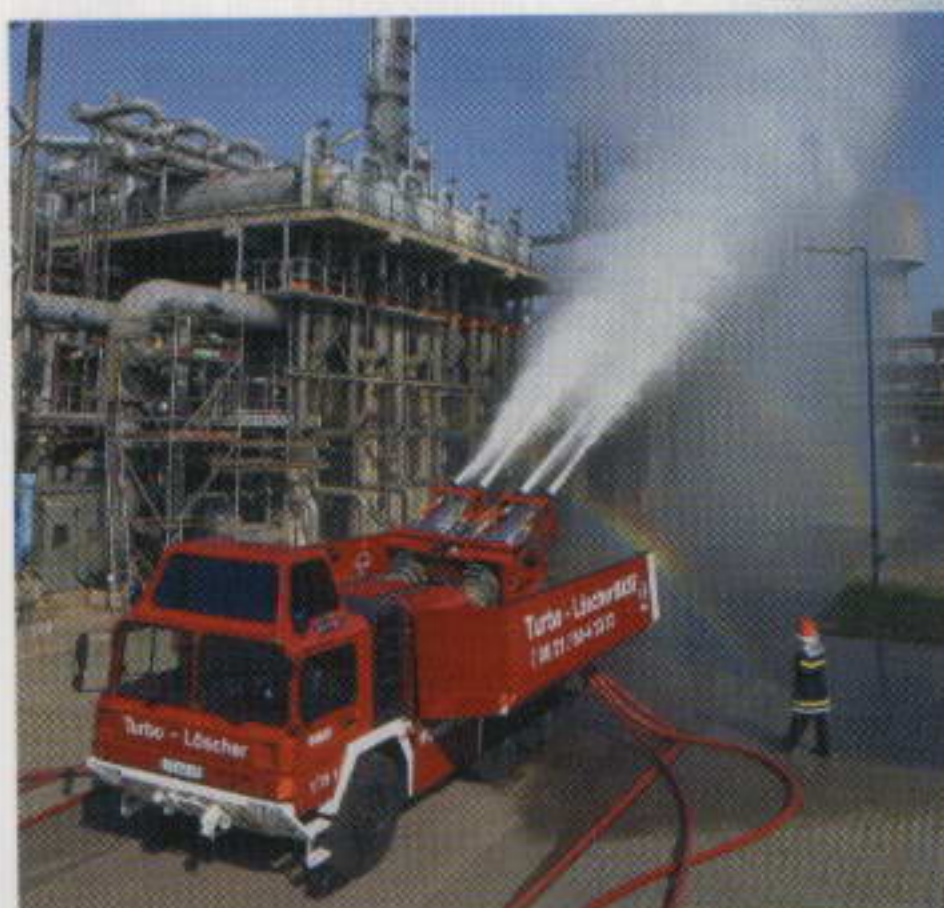
Turbolöschers zerstäuben Wasser zu feinen Tröpfchen und ersticken die Flammen in kürzester Zeit.
