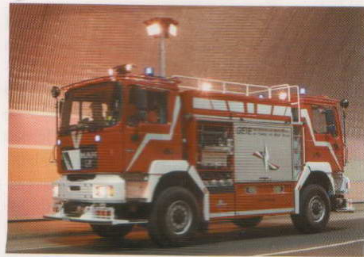
Das Löschfahrzeug für Tunnelbrände hat zwei Führerhäuser. Das erspart dem Maschinisten im Montblanc-Tunnel das Rückwärtsfahren.
