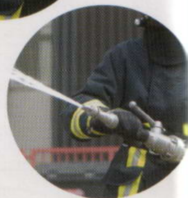
Hebel nach hinten: Sprühstrahl. Hebel nach vorn: Vollstrahl.
