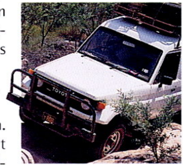
Solche Rammschutzbügel wird es ab 2002 bei Geländewagen nicht mehr geben. Sie haben bei Unfällen viele Kinder schwer verletzt und wurden deshalb von der EU verboten.
