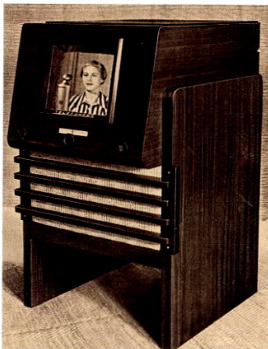
Der Telefonken- Fernseher FE IV, ei- nes der ersten Pri- vatmodelle von 1935, hatte noch ein sehr großes Gehäuse. Der Bild- schirm war dage- gen noch ziemlich winzig.
