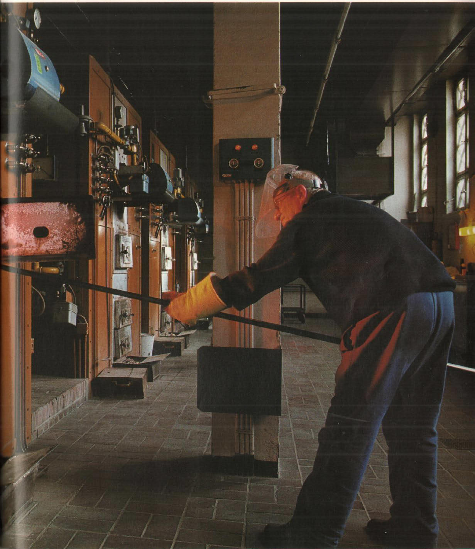
verwandeln. Mit dem Schüreisen stoçert er in der Hauptbrennkammer. Metallteile, die aus der Ausbrennkammer in den Aschekasten fallen, sammelt er - für den Schrottplatz
