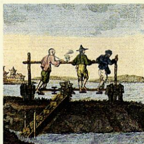
Die Kettenpumpe zur Bewässerung der Reisfelder.
