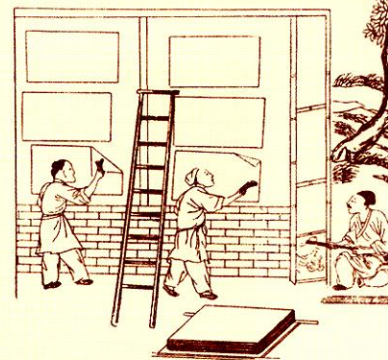
Trocknen der Schicht auf einer erhitzten Mauer und Ablösen des trockenen Blattes
