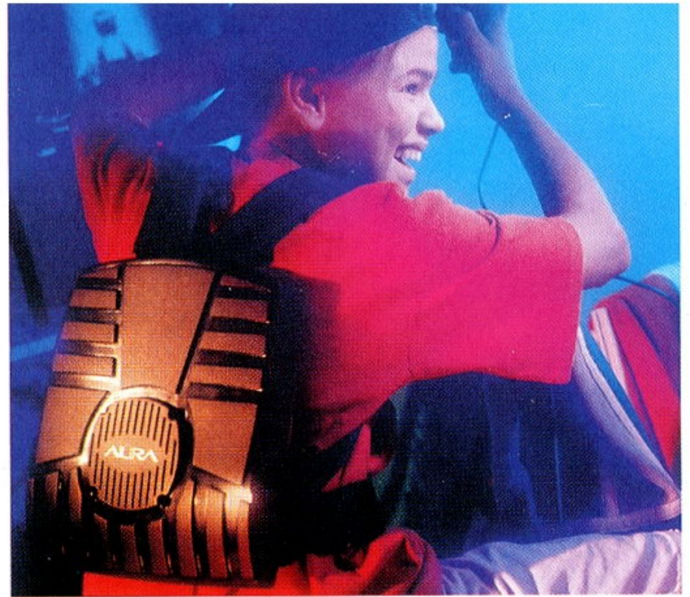
Datenanzug für „virtuelles Boxen“. Er enthält Einrichtungen, die dem virtuell Getroffenen das Gefühl eines Boxhiebes vermitteln.
