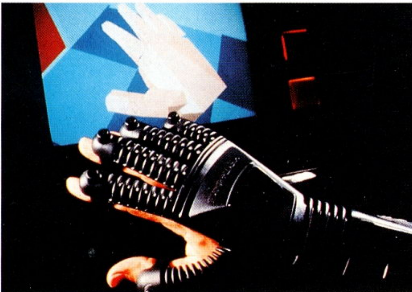
Ein Datenhandschuh, mit dem man in virtuelle Handlungen eingreifen kann, der aber auch entsprechende Empfindungen in der Hand erzeugt.
