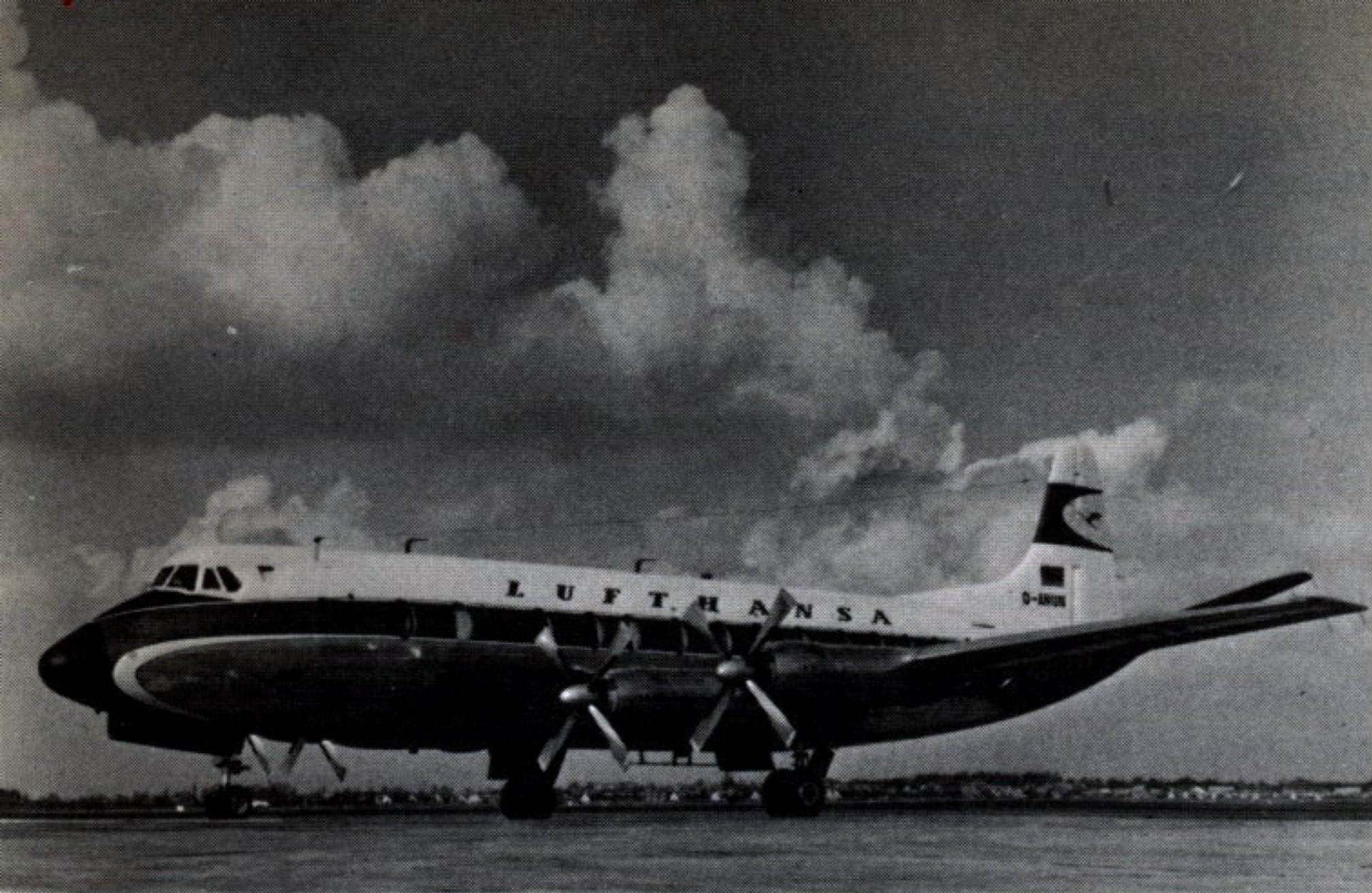
Vickers Viscount 814, ein Turboprop für 64 Passagiere, fliegt 540 km/st.
