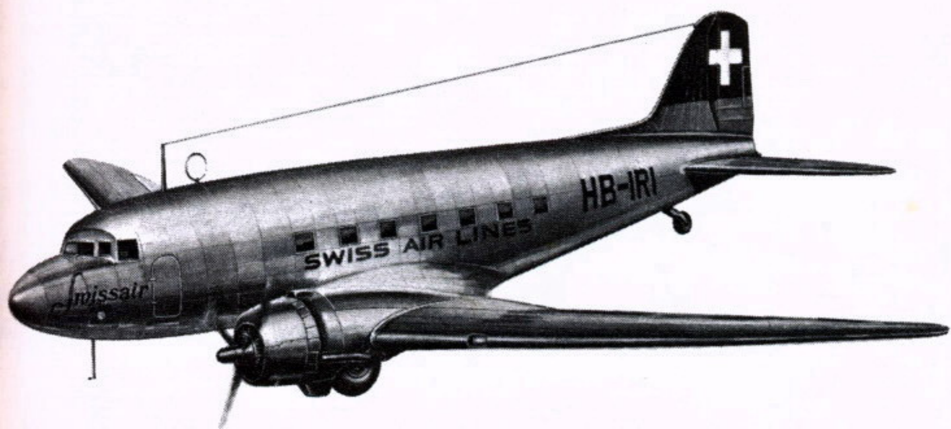
DOUGLAS DC-3, auch DAKOTA genannt. 2 Doppelsternmotoren mit je 1200 PS, bis 32 Passagiere, Fluggeschwindigkeit 300 km/st. Etwa 13 000 Stück wurden gebaut. Während des Krieges diente sie als Truppentransporter.
