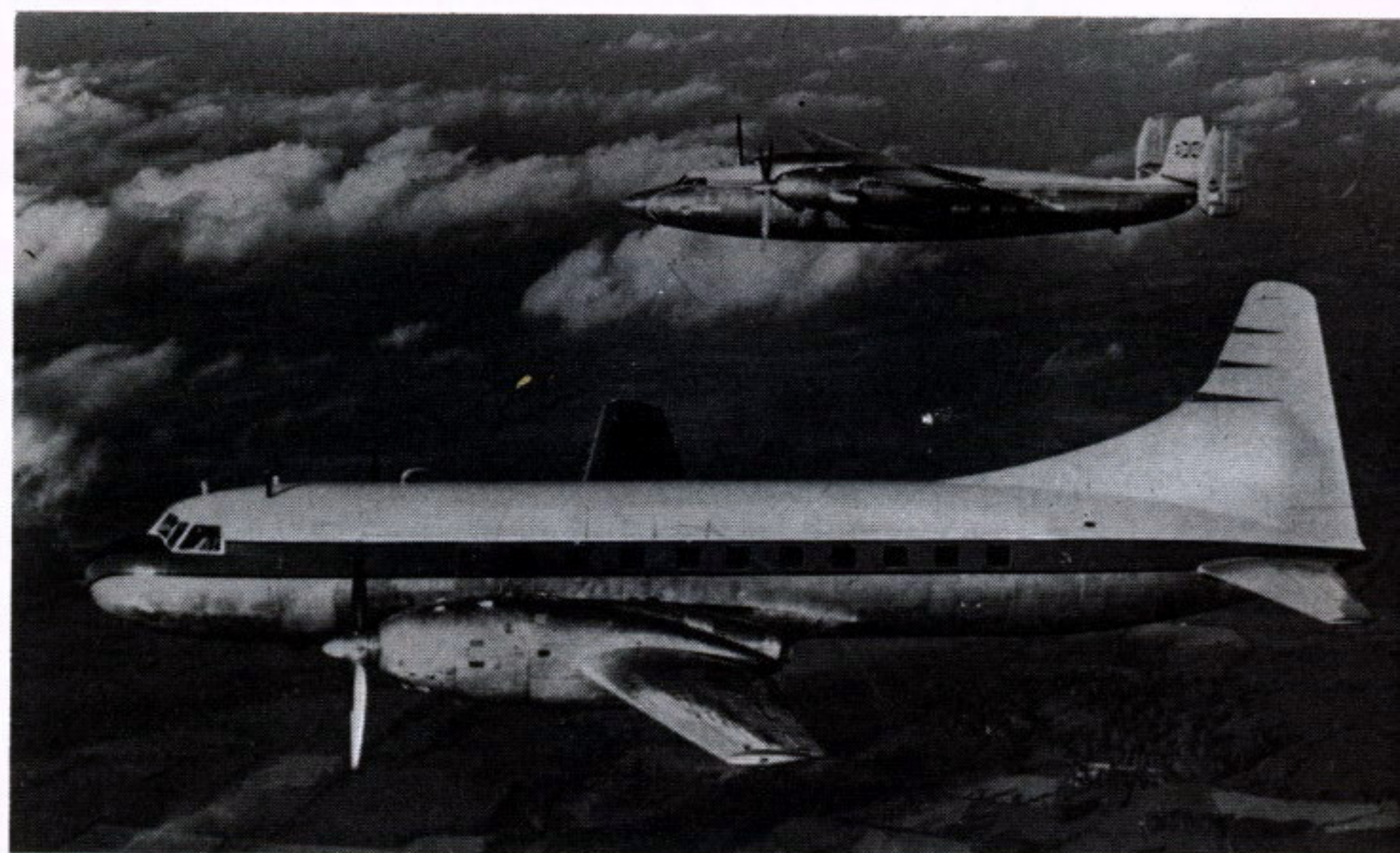
CONVAIR CV-340 für Mittelstrecken. Zwei Motoren mit je 2400 PS, 44 Passagiere, Höchstgeschwindigkeit 504 km/st in 7000 m Höhe, Reichweite 1670 km.
