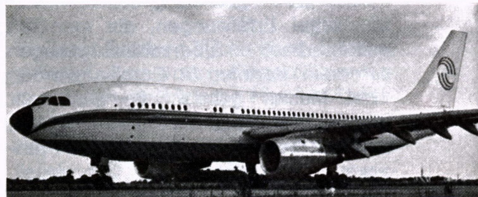
AIRBUS A 300 B, das leiseste Großraumflugzeug der Welt, mit bis zu 345 Sitzplätzen. Es fliegt 900 km/st.
