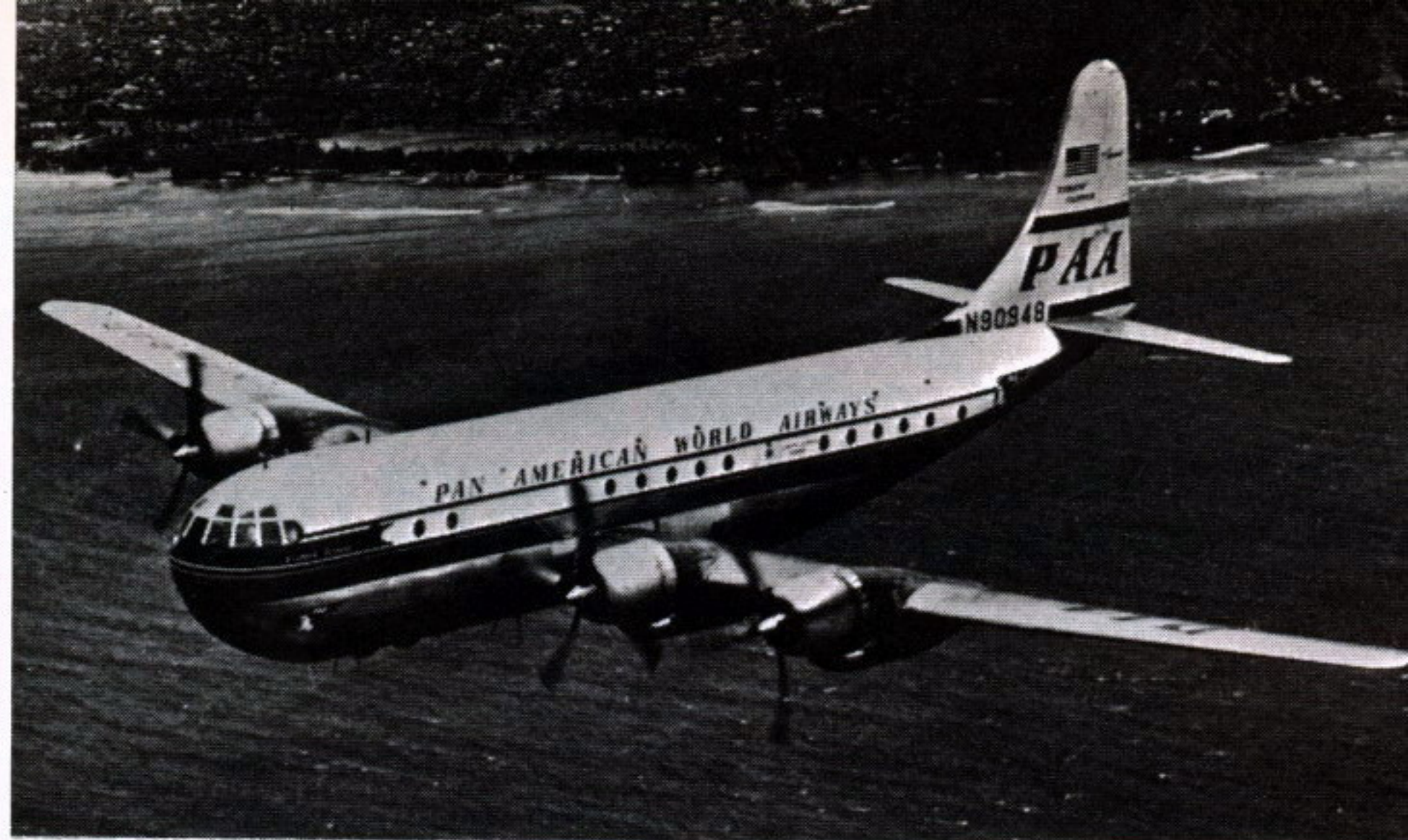
BOEING B 377 „STRATOCRUISER“, Erstflug 1944. 4 Sternmotoren mit je 3500 PS, 75 Passagiere, Geschwindigkeit 545 km/st, Reichweite 7400 km. Bis Ende der 50er Jahre im Linienverkehr.
