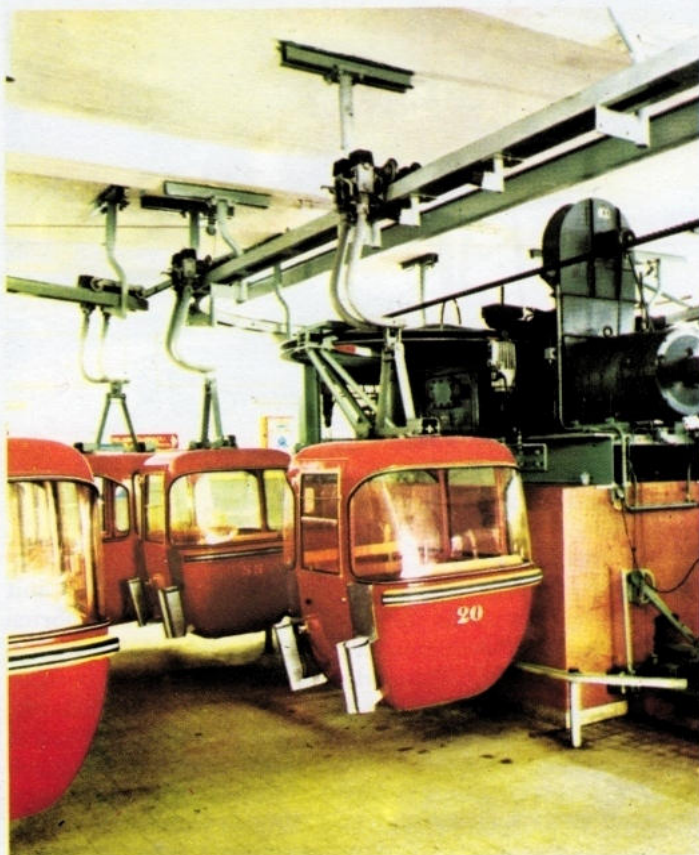
Oben: Viersitzige Seilbahnen vom Gondeltyp in der Endstation in Cry d'Er in den Schweizer Alpen. Die Seiltrommel rechts im Bild wird von Gleichstrom-Elektromotoren angetrieben.
