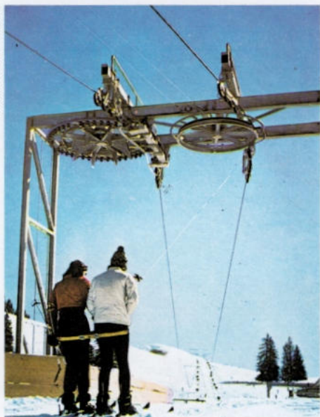
Oben: Winkelträger an einem Skilift mit Änderung der Laufrichtung der Seile. Dieser Schlepplift kann 1 000 Personen pro Stunde befördern.
