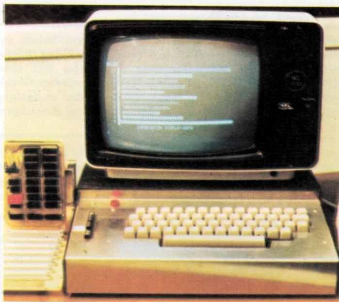
Oben: Für den Hausgebrauch wurde ein Kleincomputer entwickelt. Er kann an einen Kassettenrecorder und an ein Fernsehgerät angeschlossen werden. Die Kassette speichert die Daten und gibt sie in gleicher Weise wie aufgezeichnete Musik wieder. Die Daten werden vom Bildschirm abgelesen.
