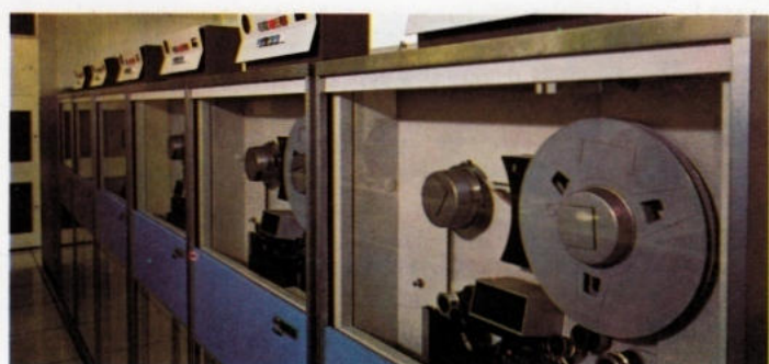
Oben: Eine Reihe von Magnetbandeinheiten. Die Magnetbänder werden auf der linken Spulennabe befestigt. Die leeren Magnetspulen (rechts) bleiben konstant an ihrem Platz.
