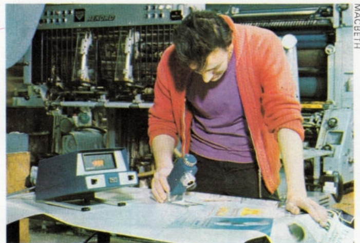
Oben: Ein computergesteuertes Densitometer. Die Daten werden auf einem Bildschirm ausgegeben.
