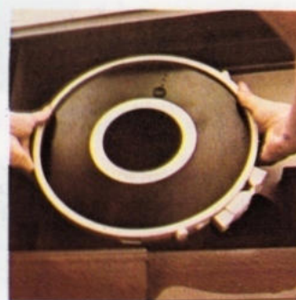
Links: Eine Magnetbandeinheit. Das Magnetband wird automatisch in den Schreib/Lesekopf eingezogen, muß allerdings von Hand eingelegt werden. Es verfügt über 7 oder 9 Spuren bzw. Zeilen, die außer einer (Parityspur) zur Speicherung von Informationen dienen.
