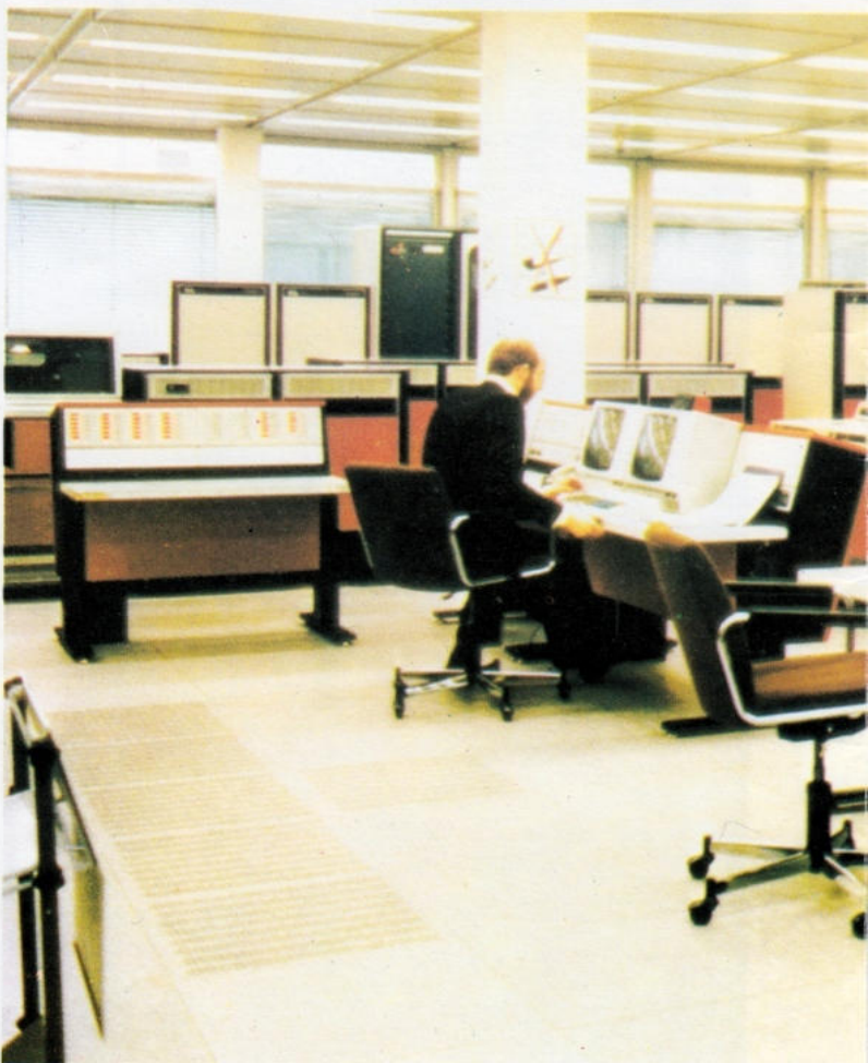
Unten: Computer bei der Europäischen Raumfahrtbehörde in Darmstadt. Die Daten werden auf Magnetplatten gespeichert. Sie befinden sich hinter den Bildschirmen, auf denen die Information ausgegeben wird. Hinter den Plattenspeichereinheiten sind die Speichereinheiten zu sehen.
