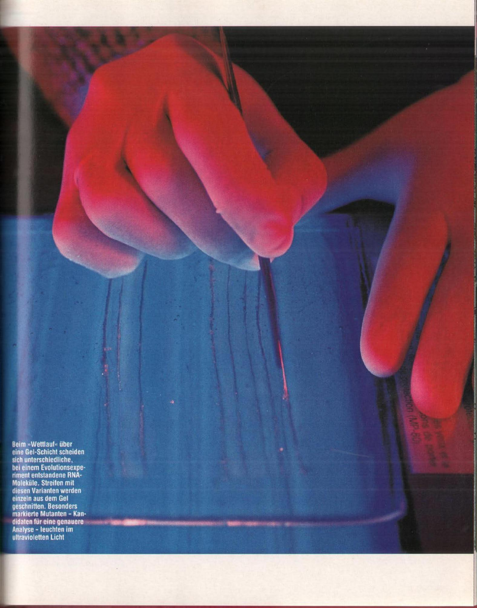
Beim »Wettkauf« über eine Gel-Schicht scheiden sich unterschiedliche, bei einem Evolutionsexperiment entstandene RNA-Moleküle. Streifen mit diesen Varianten werden einzeln aus dem Gel geschnitten. Besonders markierte Mutanten – Kandidaten für eine genauere Analyse – leuchten im ultravioletten Licht
