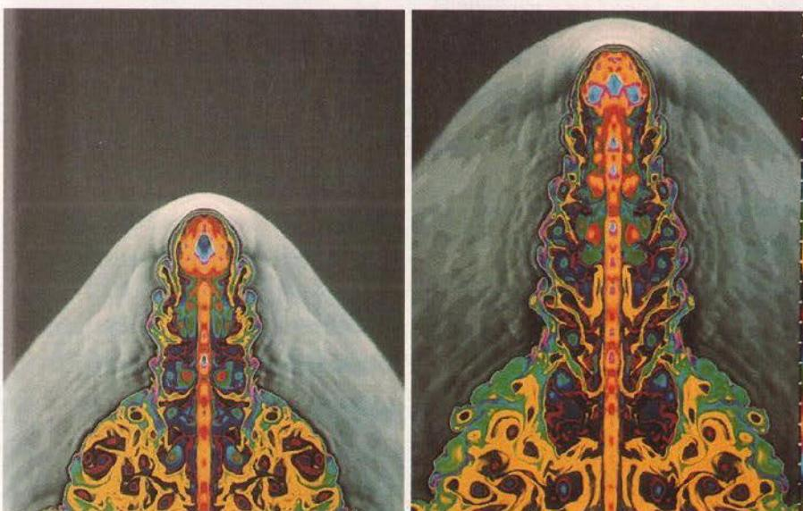
Computermodelle ersetzen unmögliche oder kostspielige Experimente: Sequenzen eines simulierten überschallschnellen Gasstroms
