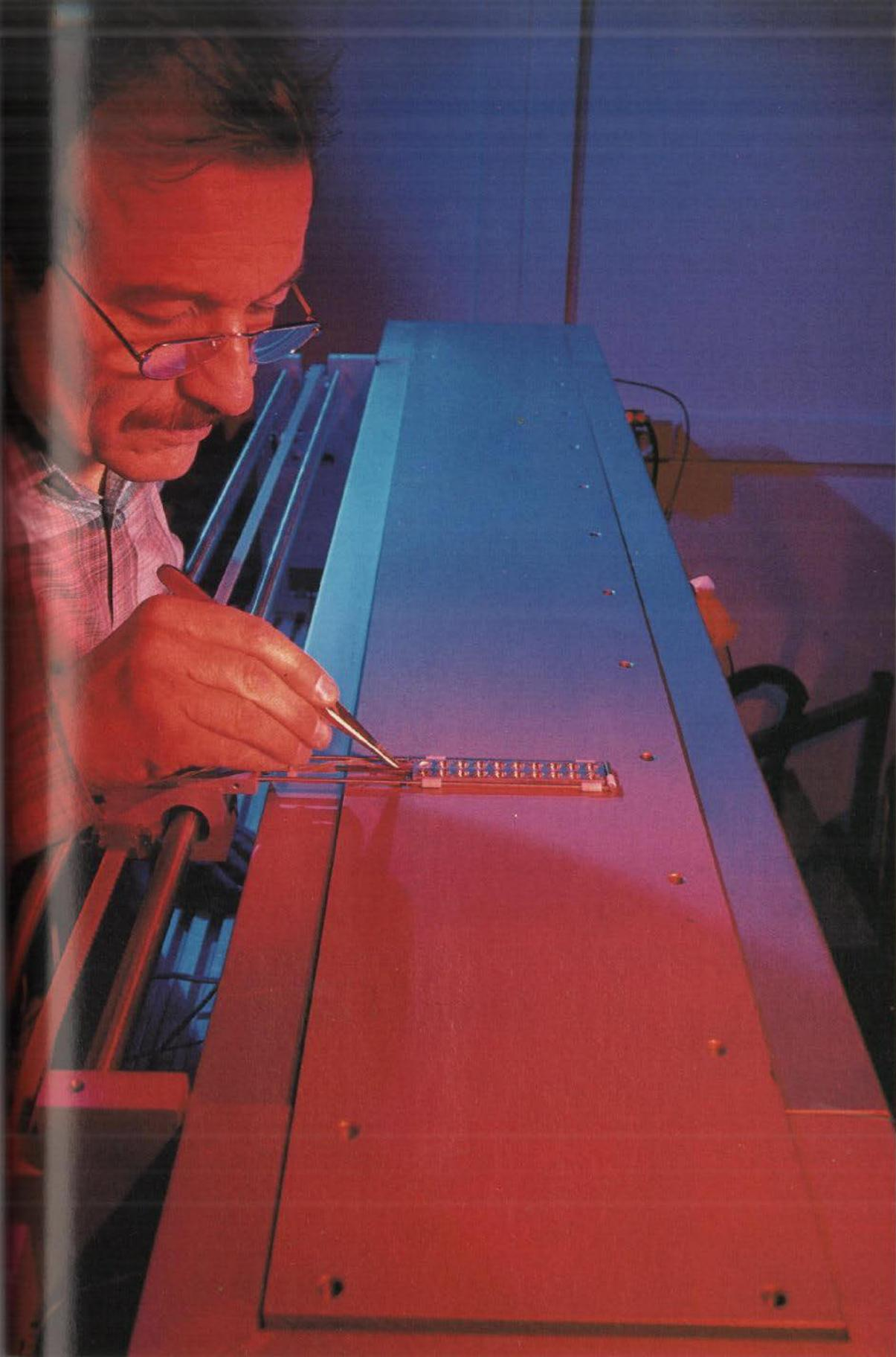
Roderich Weise, der Elektroniker in Manfred Eigens Forschungsgruppe, arbeitet am Prototyp einer neuartigen Versuchsapparatur. Um Evolutionsprozesse anzuregen, fährt ein mechanischer Arm mehrere RNA-Proben sehr schnell von kalten in heiße Zonen und umgekehrt. Ein Bündel von Laserlicht führenden Glasfasern (Bild links) erlaubt, die RNA-Konzentration in sehr vielen Gefäßen gleichzeitig zu bestimmen
