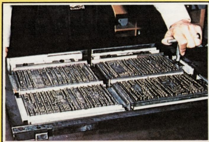
Oben: Nach Korrektur der Satzschiffe wird die Druckform in einen Schließrahmen eingespannt, nachdem die Seiten richtig ausgeschossen wurden. 'Ausschießen' bedeutet, daß die Kolumnen im Schließrahmen so angeordnet werden, daß nach dem Falzen des gedruckten Papierbogens die Seiten in richtiger Reihenfolge erscheinen.
