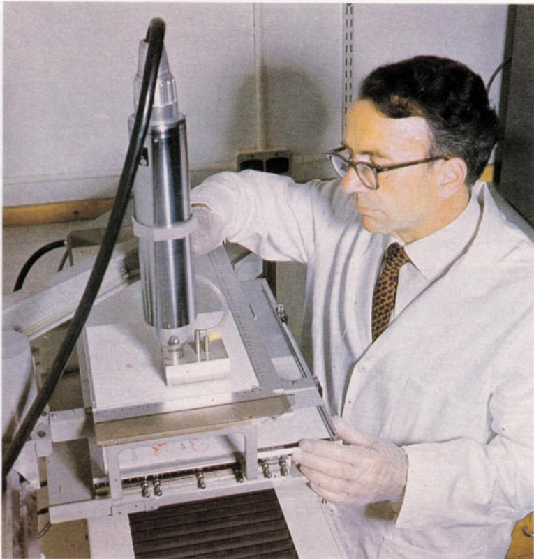
Oben: Gaschromatograph im Baukastensystem, ein Gerät, wie es heute zu erschwinglichen Preisen im Handel erhältlich ist.
