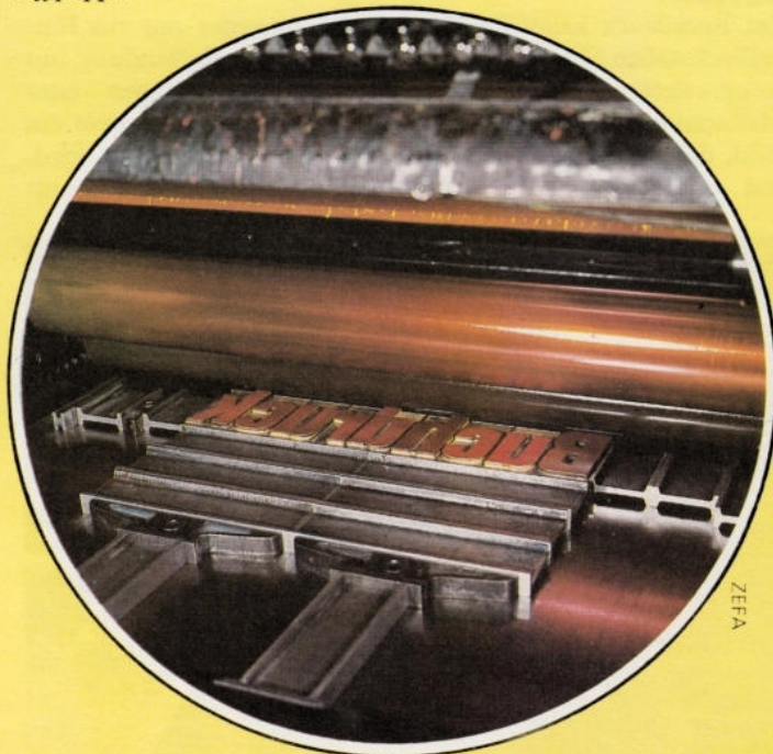
Oben: Die fertige Druckform steht in der Schnellpresse waagrecht auf dem Fundament. Der Druckbogen wird nach dem Einführen vom Druckzylinder über die Form gerollt.
