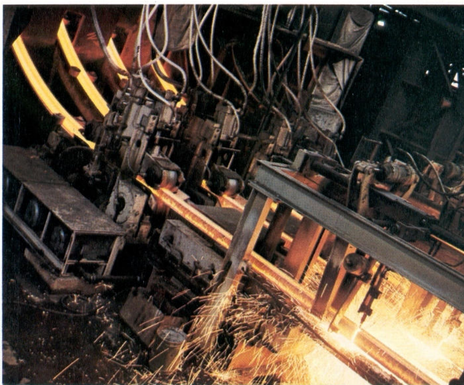
Oben: Eine große Schneidbrennmaschine, bei der vier Schneidbrenner auf einem Rahmen angebracht sind.
