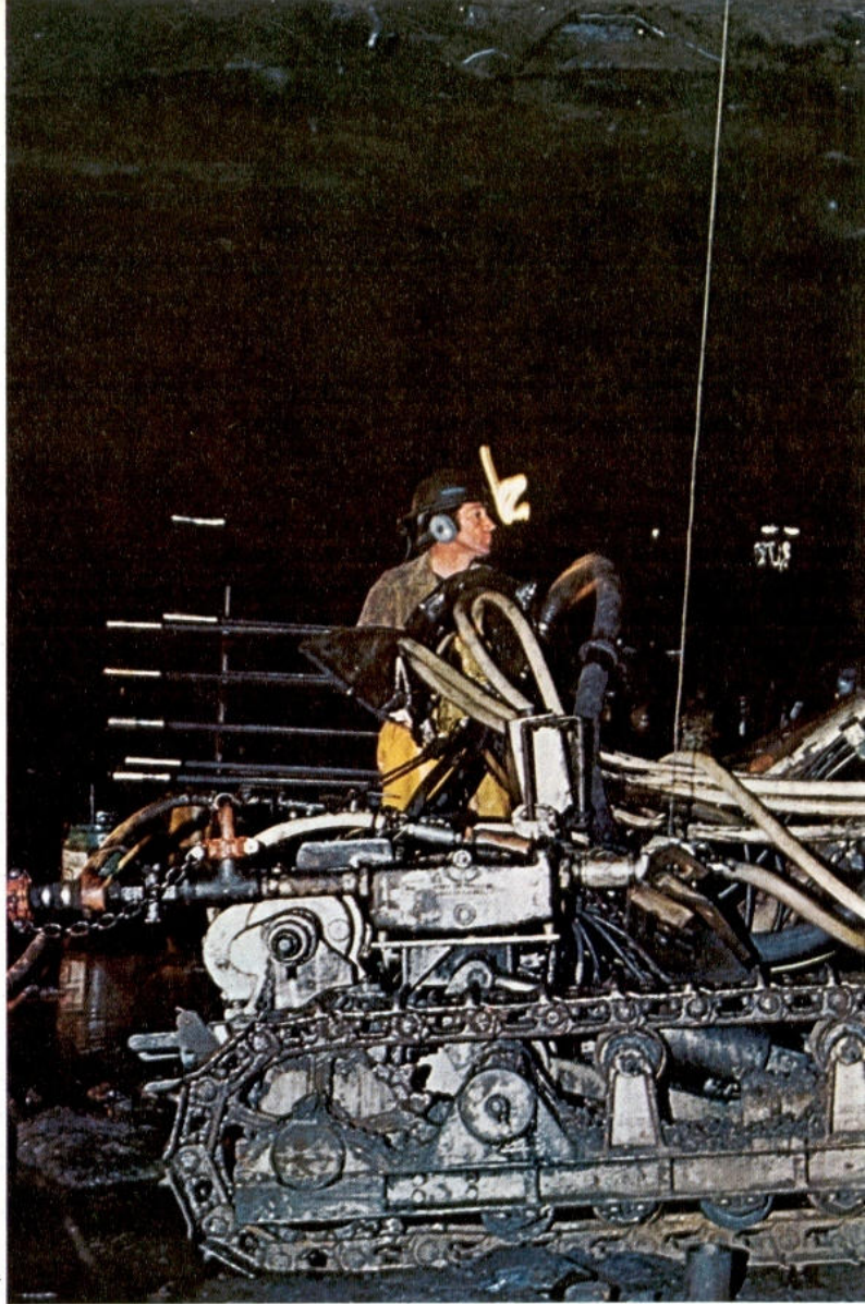
Oben: Eine Luftdruck-Langlochbohrung in einer Erzkammer — das Ausschachten des Erzes aus einer Ader. Der Bohrer kann
