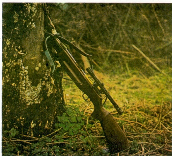
Oben: Eine moderne Armbrust zum Zielschießen und zur Jagd. Dieses Modell hat eine maximale Zugkraft von 680 N. Der Bolzen hat eine Geschwindigkeit von mehr als 120 m/s und eine Reichweite von mehr als 300 m.
