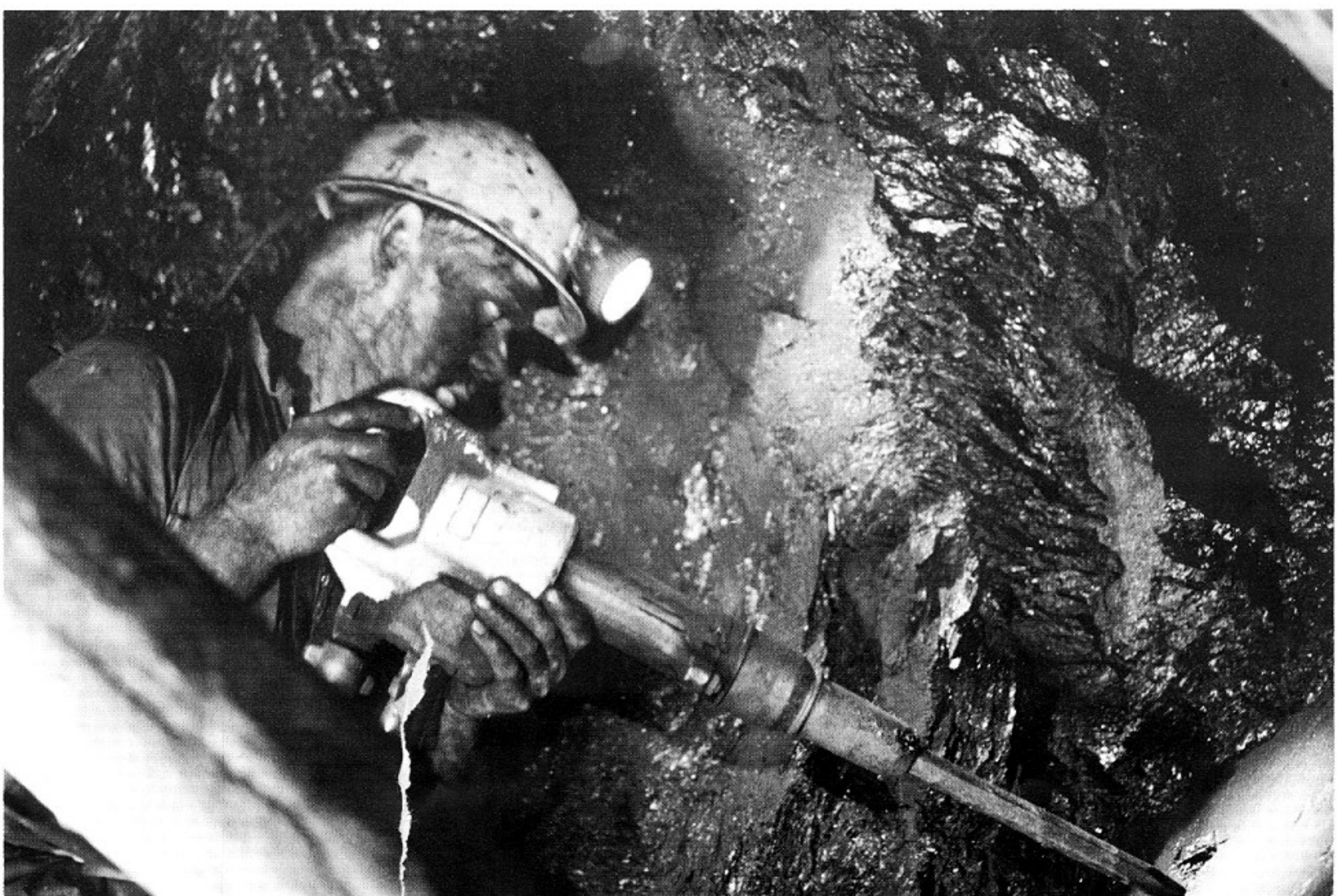
Abbau der Kohle mit dem Preßlufthammer: Bergmann in einer Zeche, 975 m unter Tage.
