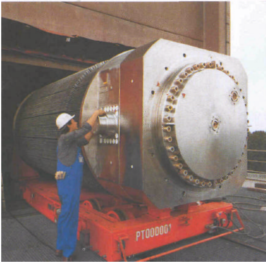
Arbeiten an einem Transportbehälter für verbrauchte Brennelemente. Diese Behälter gehören zu den stabilsten Konstruktionen der Technik.
