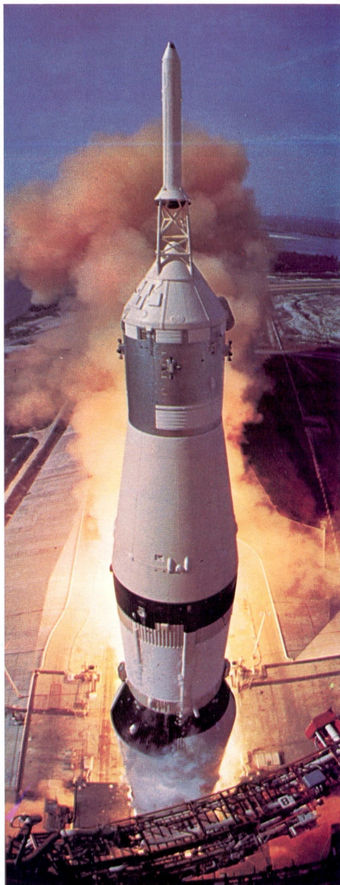
Abheben des Apollo-11-Raumschiffes im Juli 1969. Oben — auf der Spitze der Kommandokapsel — befindet sich eine kleine Rakete. Diese soll in einer Gefahrensituation die Kommandokapsel von der Saturn-V-Rakete abheben, um eine Rückkehr zur Erde sicherzustellen.
