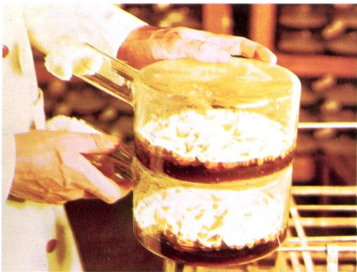
Oben: Penicillinkulturbehälter aus Glas vor 30 Jahren. Der Inhalt ist eine Pinselschimmelpilzkultur (Penicillium). In der Endphase der Herstellung wird das Penicillin in großen Tanks aus rostfreiem Stahl fermentiert.
