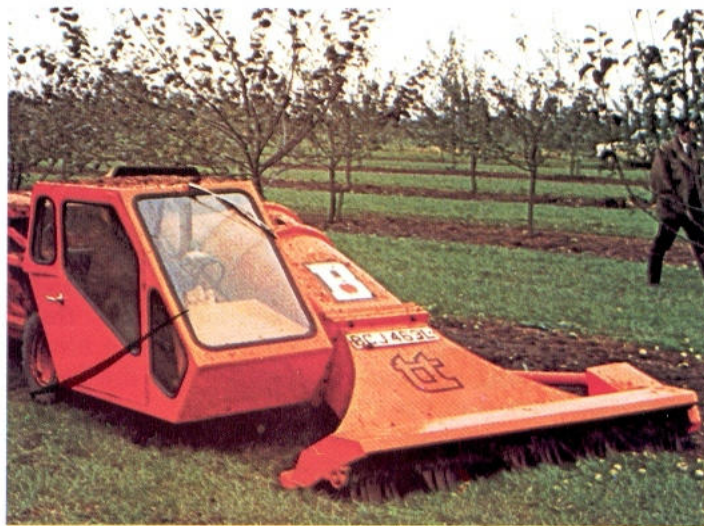
Oben: Diese Erntemaschine pflückt alle fünf Minuten eine Tonne Äpfel. Sie arbeitet wie ein riesiger Staubsauger. Zusätzlich besitzt sie eine Vorrichtung, die die Äpfel von Abfall, wie Blättern und Zweigen, trennt.
