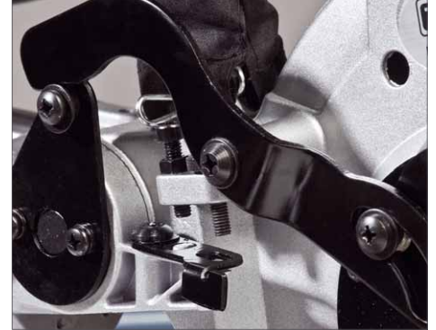
Einfach und funktional: die Schnitttiefengrenzung für Einsetzschnitte
