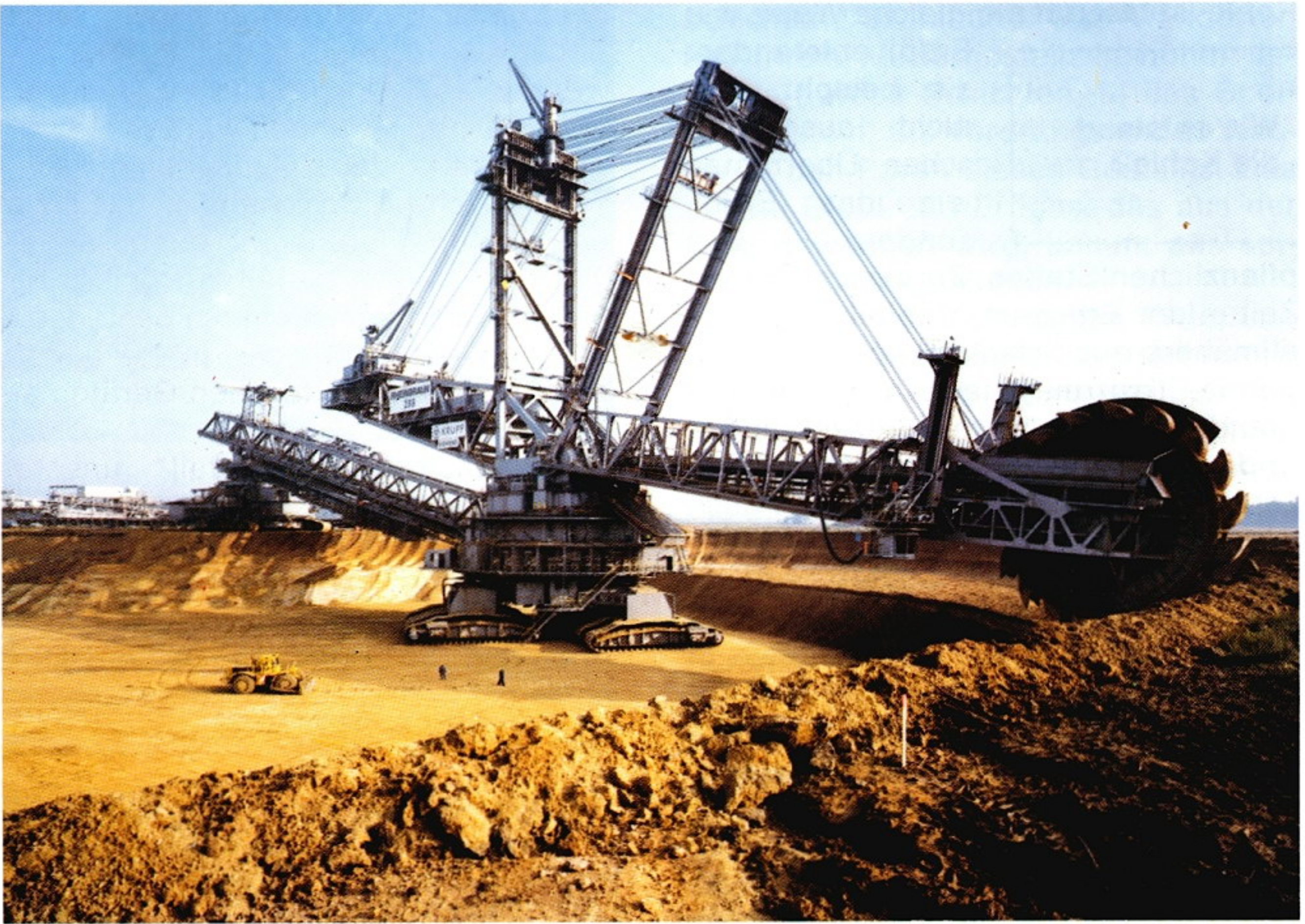
Dieser 225 m lange Riesenbagger ist das größte fahrbare Fördersystem der Welt. Er wird im Rheinland zum Abbau von Braunkohle eingesetzt.
