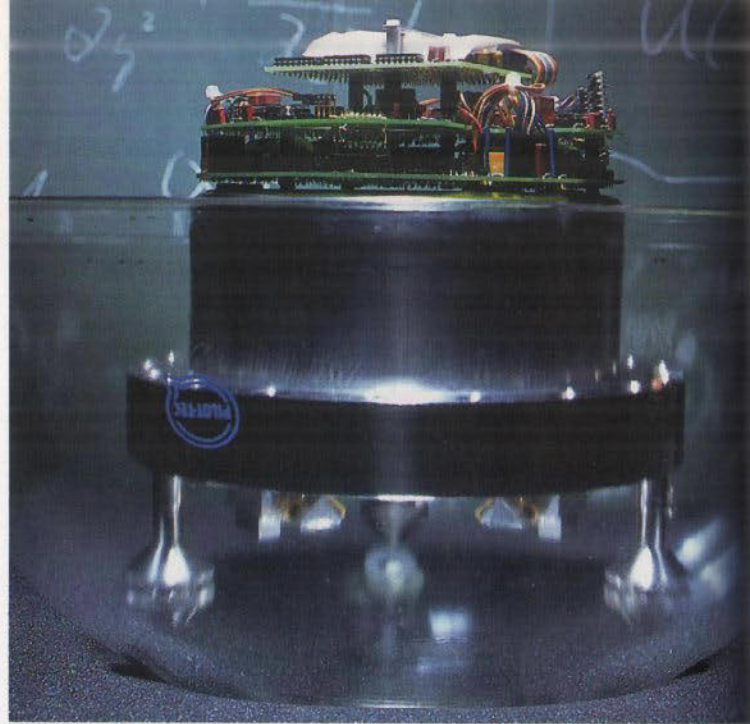
Prototyp für den Einsatz im Ozean: Forscher haben Sensoren entwickelt, die, von Glas umhüllt und frei drehbar aufgehängt, Erdbebenwellen direkt auf dem Meeresboden registrieren
